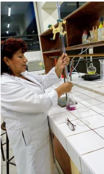
**Figura 21.** Titulando con tiosulfato de sodio.
