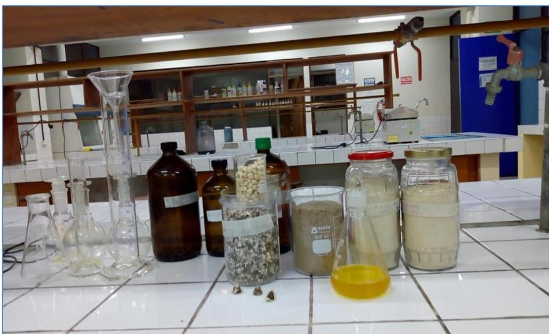
**Figura 15.** Mostrando la materia prima con cascara, pelada, secada triturada y tamizada y producto final aceite de moringa.
