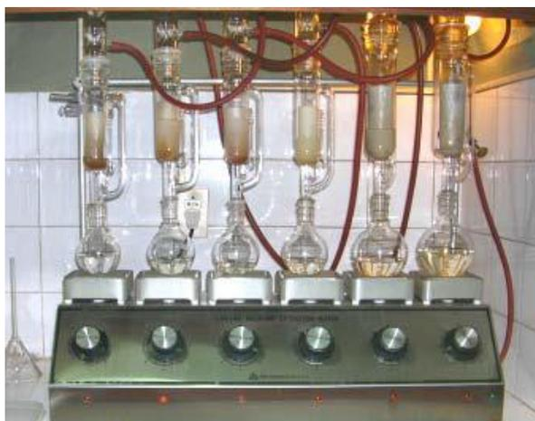
**Figura 6.** Calentador múltiple con seis equipos de extracción.
