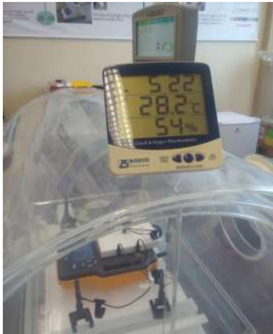
**Fig.66** Medición de la temperatura ambiente fuera del habitáculo
