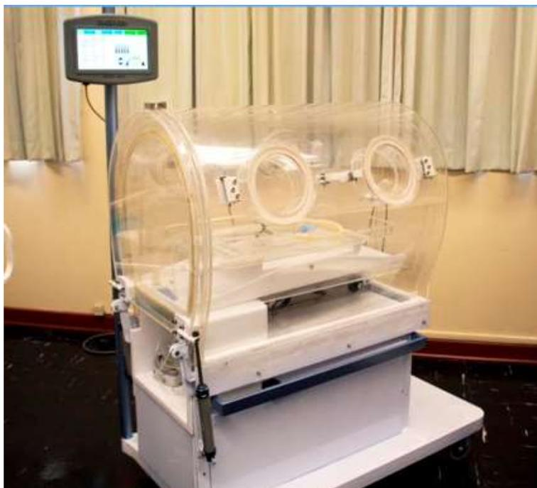
**Fig.70** Prototipo final de la Incubadora con tres capas aislantes
