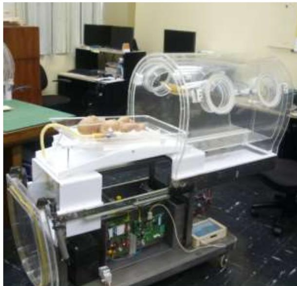
**Fig.32** Construcción del prototipo de la Incubadora con ventilador artificial
