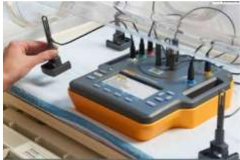
**Fig.12** Analizador de Incubadoras/Cunas térmicas INCUII
