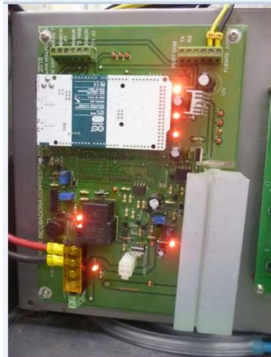
**Fig.55** Módulo de control usando Arduino Due
