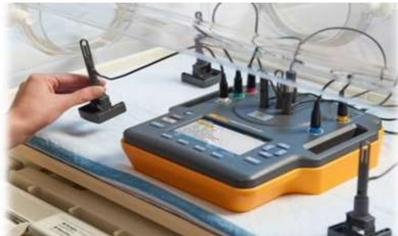
**Fig.31** Analizador de incubadoras
