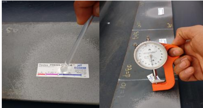
Figura 26. Medición de rugosidad con cinta réplica Fuente: elaboración propia
