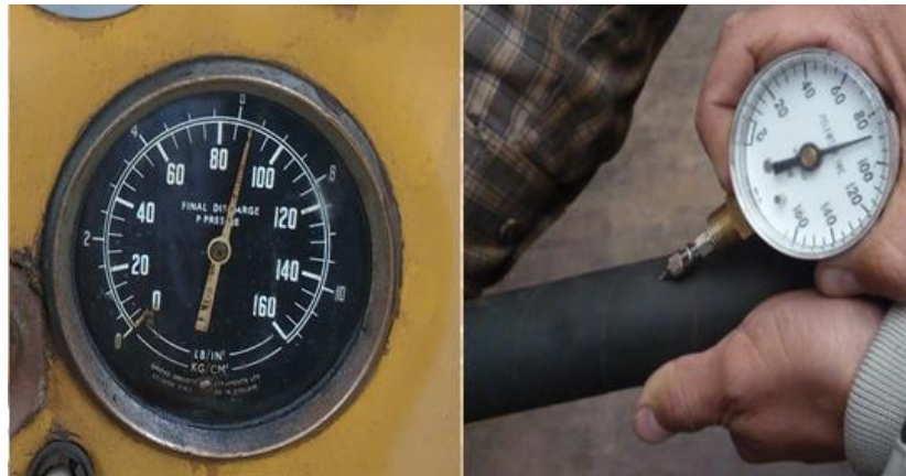
Figura 22. Prueba de aguja hipodérmica (ASTM-D4285). Con la que se determina la caída de presión de la compresora a la boquilla. Fuente: elaboración propia
