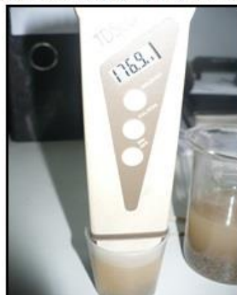
FIG N° 3 Conductividad del abrasivo
