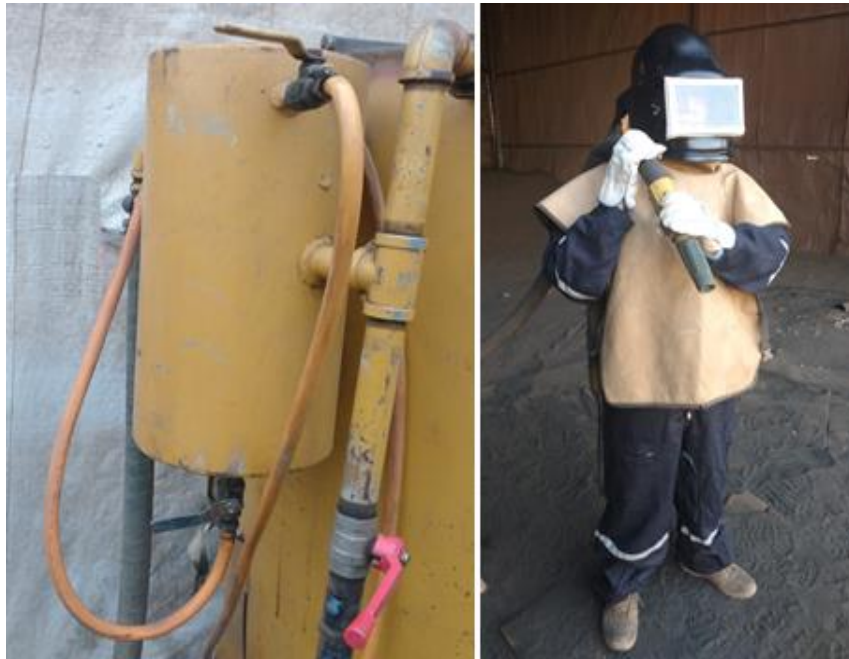
Figura 17. Extractor de humedad – Traje de escoriado Fuente: elaboración propia
