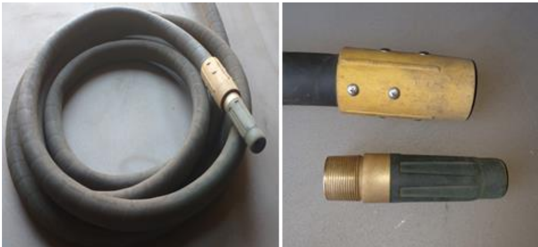
Figura 16. Manguera y boquillas Fuente: elaboración propia
