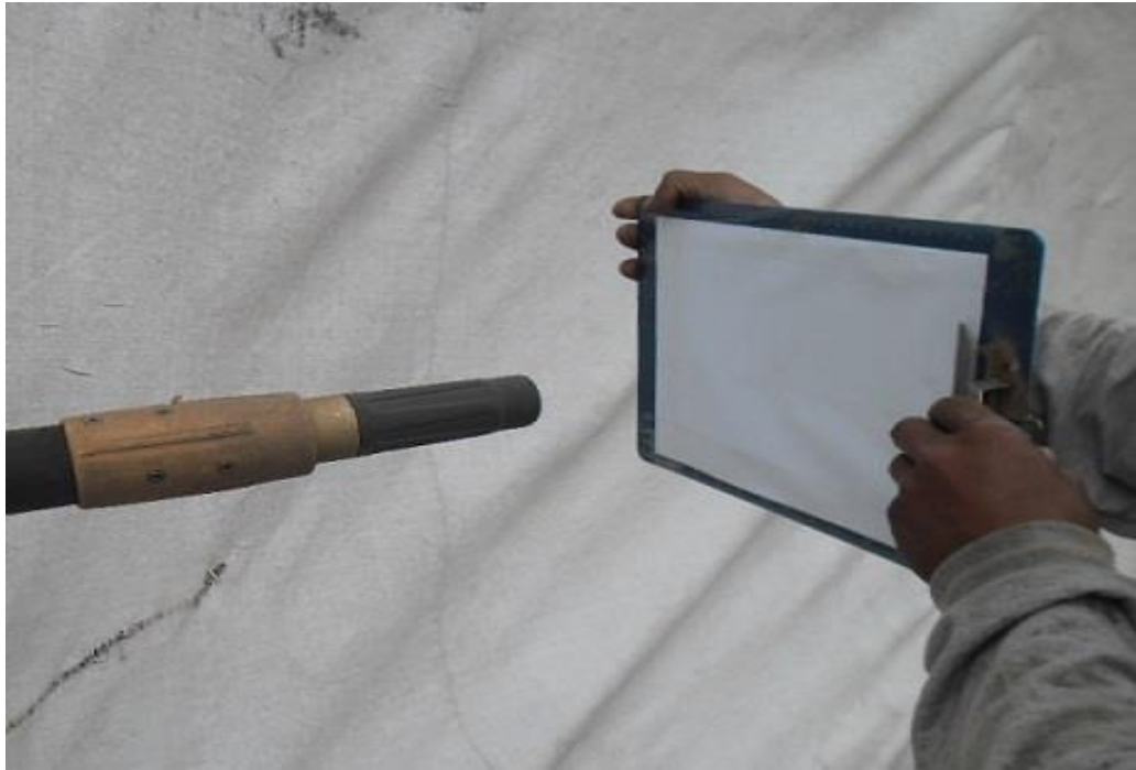
Figura 19. Inspección de humedad y grasa Fuente: elaboración propia
