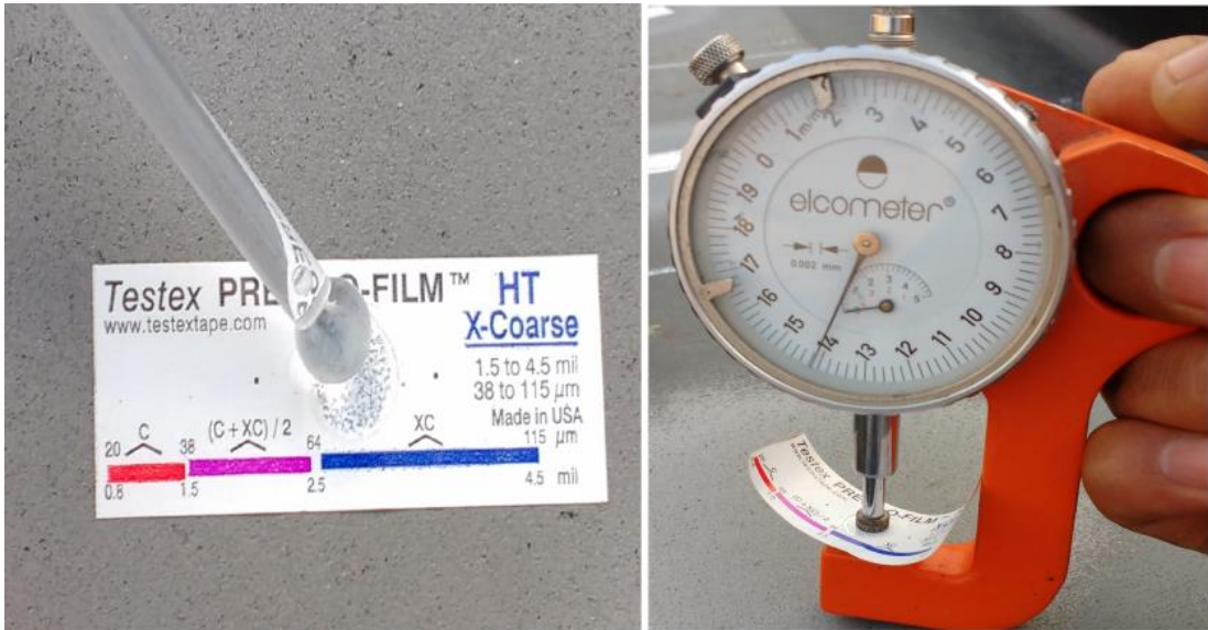
Figura 8. Cinta réplica y medidor de rugosidad.
