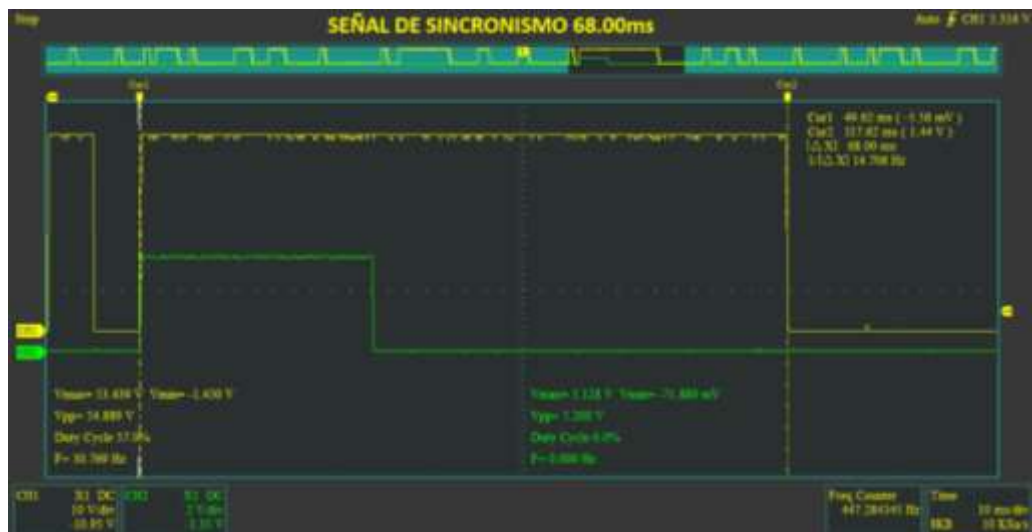
Figura 108: Señal de sincronismo del telegrama de datos actuales.
