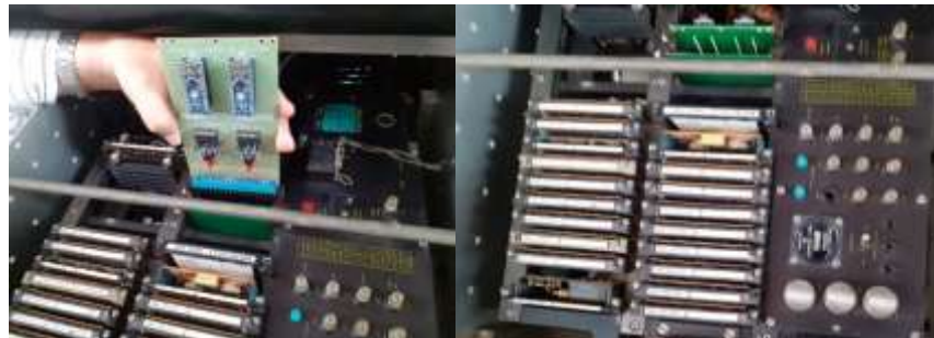
Figura 109: Tarjeta Decodificadora instalado en el Test-stand.
