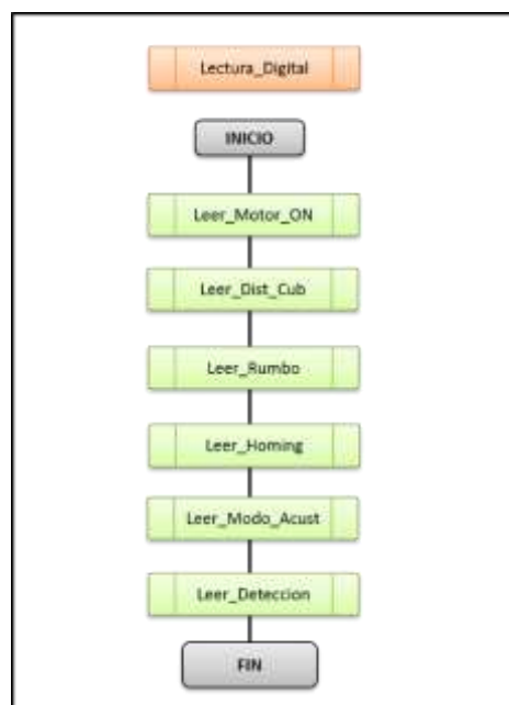
Figura 40: Diagrama de flujo de la función Lectura-Digital.
