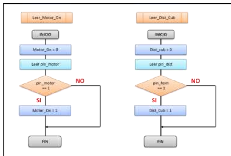
Figura 41: Diagrama de flujo de la función “Leer: Motor_On y Dist_Cub”.
