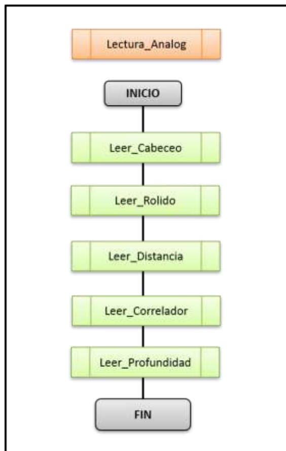
Figura 55: Diagrama de flujo de la función “Lectura_Analogo”.
