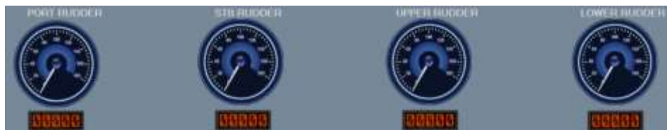
Figura 85: Modernización de los instrumentos de medición de los timones.
