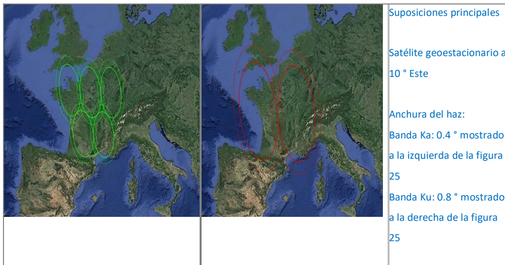
Fig. 25: Típicos haces tipo spot beam (puntuales) de -3dB y -5dB. Comparación entre la banda Ka (izquierda) y la banda Ku (derecha) solo ocurren durante periodos de tiempo muy limitados
