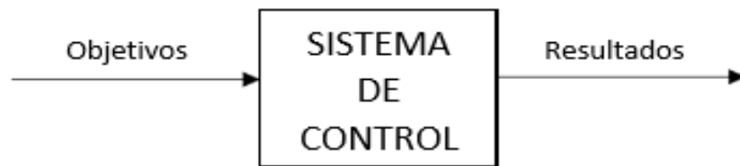
Gráfico 3 Componentes básicos de un sistema de control
