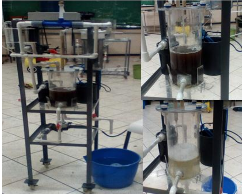
Figura 9. Equipo de proceso de oxidación avanzada ozono-UV Se aprecia como el equipo de proceso de oxidación avanzada empieza a operar, aun lado se observa el agua residual antes y después de ser tratada.
