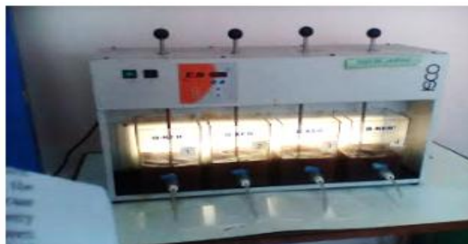
Figura 8. Coagulación-floculación del agua residual en el test de jarras. Coagulación con sulfato de aluminio para volúmenes de 1 litro en cada jarra.
