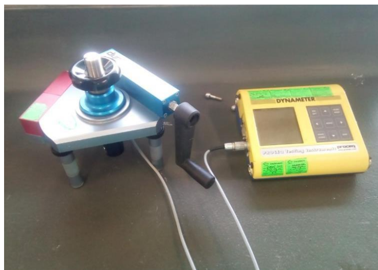
Figura 25. Dinamómetro Proceq Z16E acoplado a su panel digital. Elaboración propia
