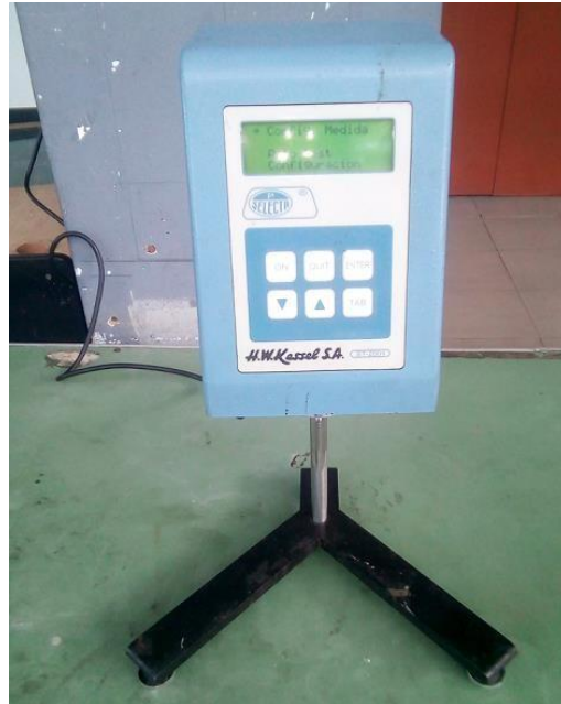
Figura 28. Viscosímetro rotacional J.P. Selecta modelo ST 2001. Elaboración propia
