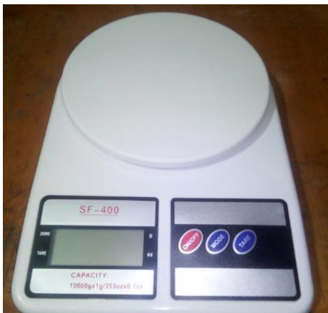
Figura 26. Balanza gramera digital de 10 Kg de capacidad Elaboración propia
