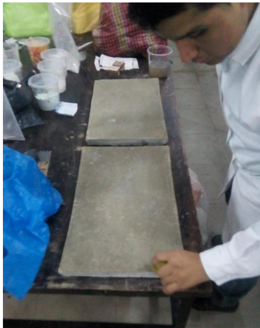
Figura 23. Placas de concreto para el pegado de las baldosas Elaboración propia
