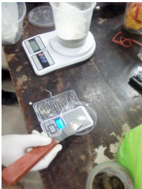
Figura 29. Pesaje de aditivos para la preparación del pegamento Elaboración propia
