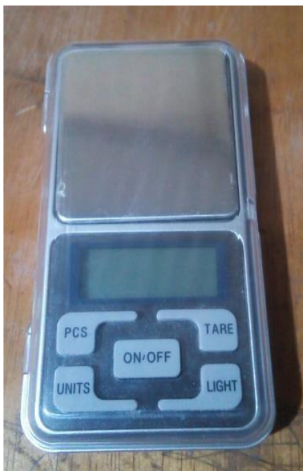
Figura 27. Balanza digital de 0.01 g de sensibilidad Elaboración propia
