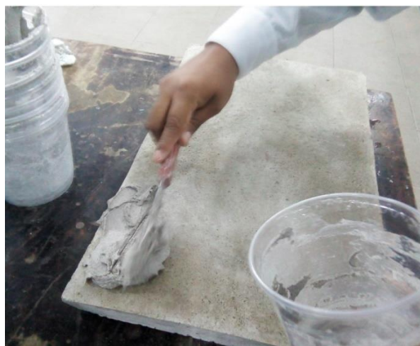
Figura 34. Untado de la muestra pegamento sobre la placa de concreto Elaboración propia
