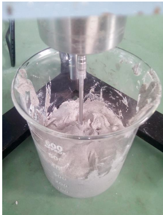
Figura 42. Lectura de la viscosidad en la muestra de pegamento Elaboración propia
