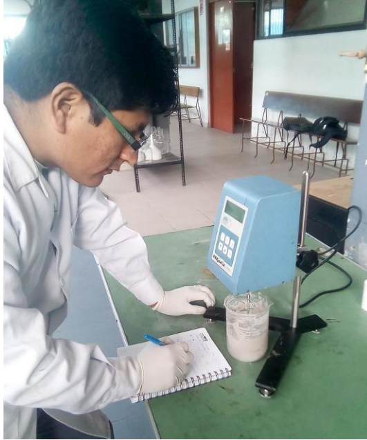
Figura 41. Determinación de la viscosidad de cada muestra. Elaboración propia
