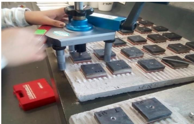
Figura 39. Lectura de la resistencia usando el dinamómetro Proceq Z16E. Elaboración propia
