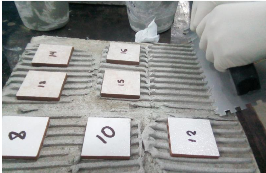
Figura 35. Formación de surcos en el adhesivo con la llana dentada. Elaboración propia
