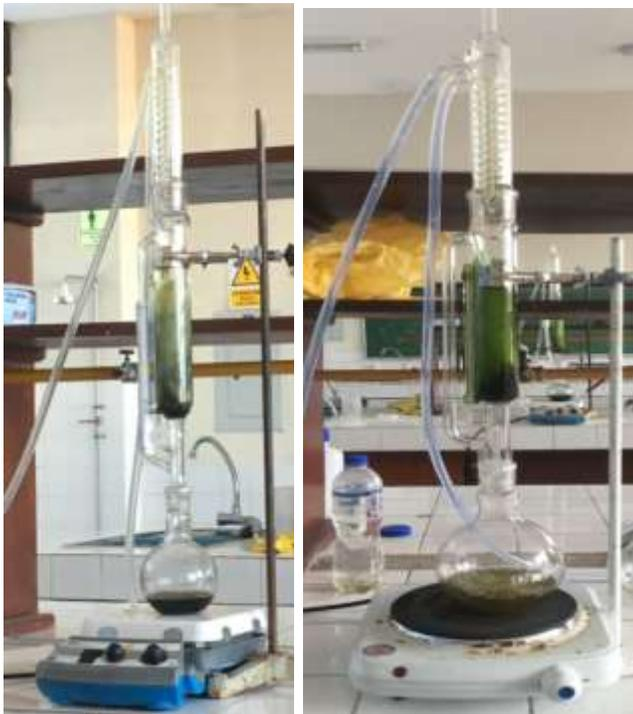
*Figura 16:* Proceso de obtención del lípido mediante Soxhlet
