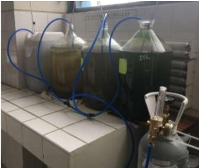
*Figura 21:* Crecimiento de *Chlorella sp* en Fotobiorreactor acondicionados con inyección de CO<sub>2</sub>
