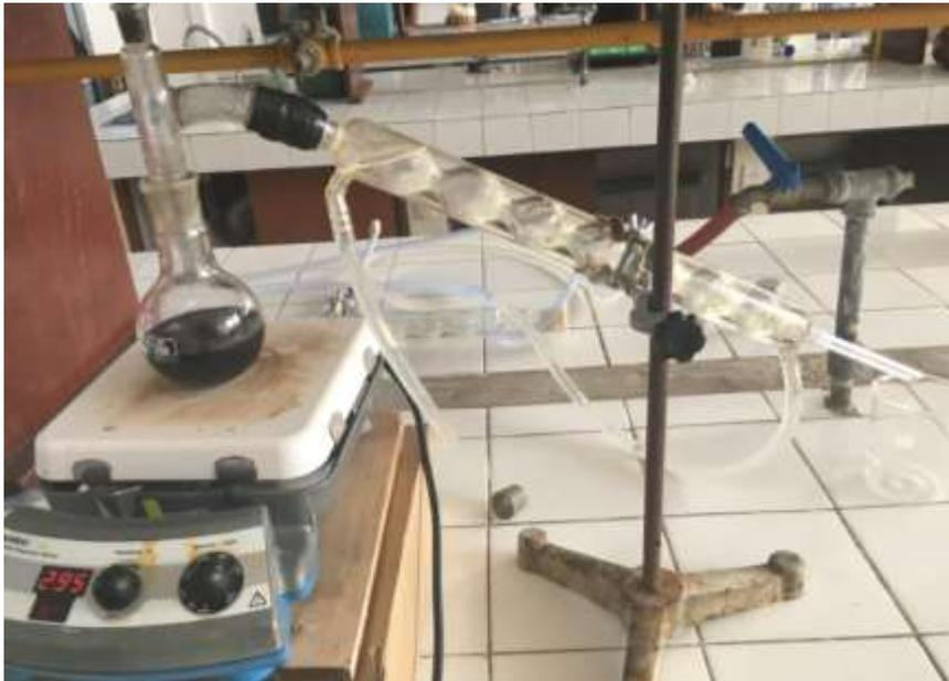
*Figura 18:* Proceso de separación del biodiesel de los demás componentes
