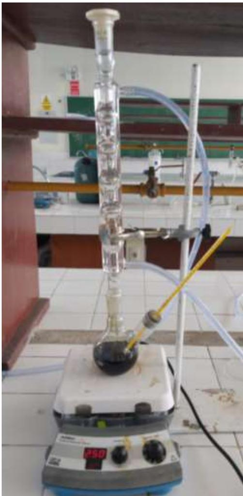
*Figura 17:* Reacción de transesterificación para la obtención del biodiesel
