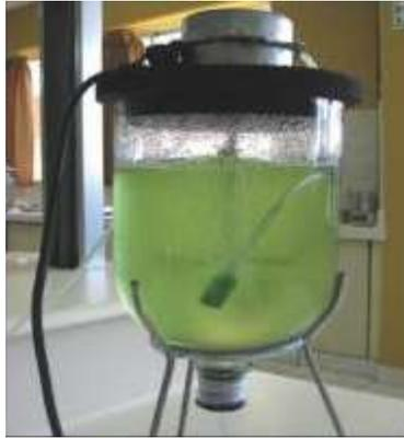
*Figura 6.* Biorreactor tanque agitado, bajo condiciones de laboratorio
