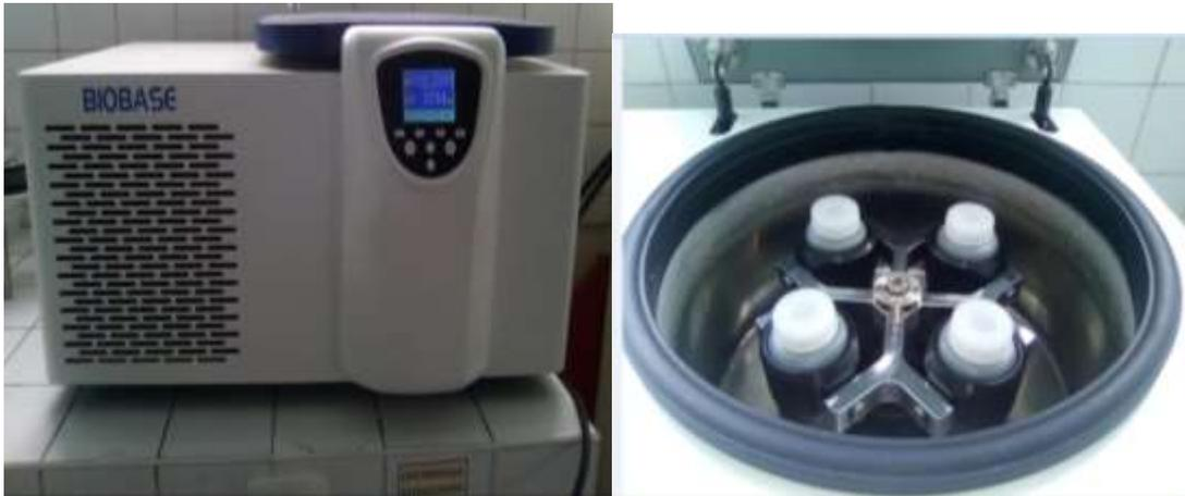
Figura 12:Centrifuga refrigerada
