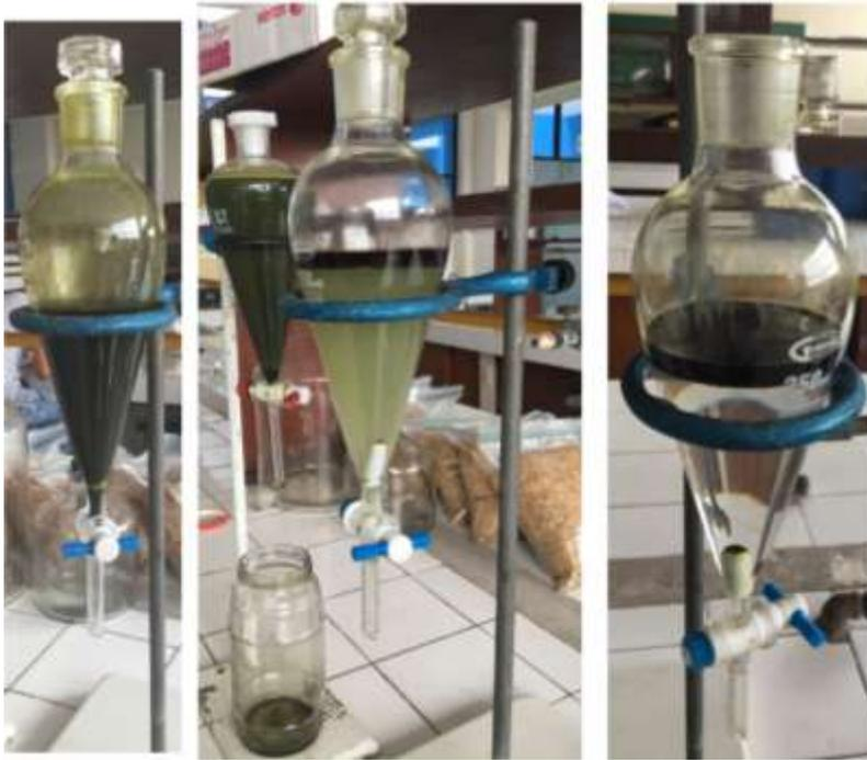
*Figura 19:* Proceso de separación del biodiesel de los demás componentes
