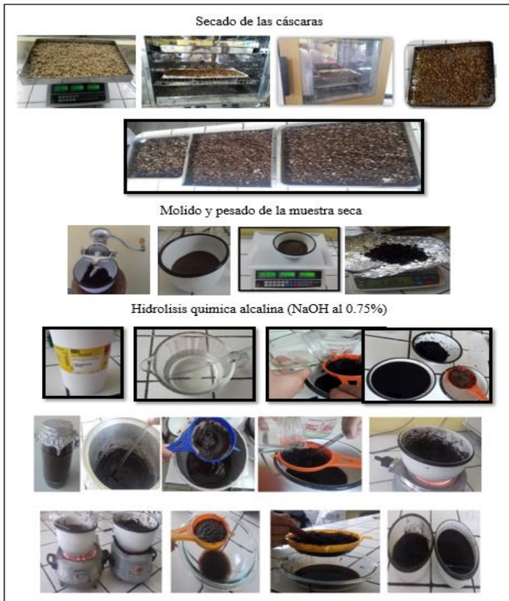
Figura N° 5.4 SECADO, MOLIDO E HIDROLISIS QUÍMICA ALCALINA DE LAS CÁSCARAS DE PLÁTANO.
