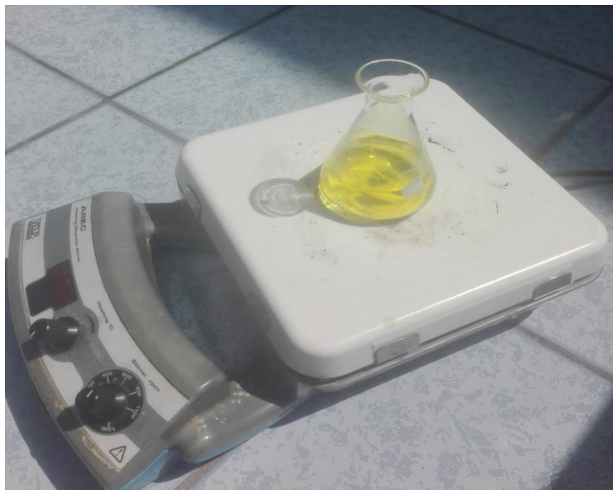
Figura 9. Exposición a radiación solar (reactor batch) de la muestra de colorante tartrazina. Elaboración propia
