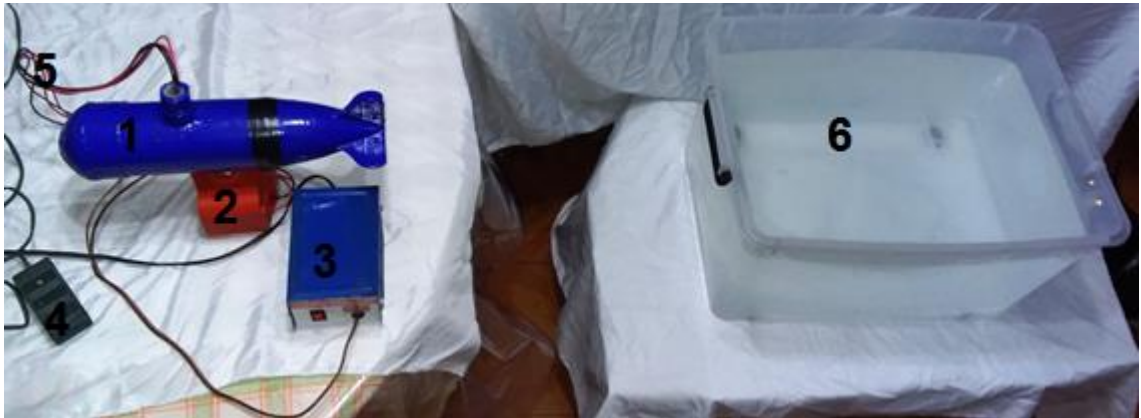
Figura 19 Esquema experimental para la prueba de propulsión MHD del modelo de minisubmarino donde mostramos (1) Casco del modelo de minisubmarino, (2) Propulsor MHD, (3) Fuente de alimentación 12 VDC, (4) Extensión, (5) Cables de alimentación, (6) recipiente de agua con sal de 50 L
