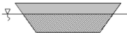
Figura 12: Área considerada para el cálculo de la fuerza de arrastre, para hidronaves.
