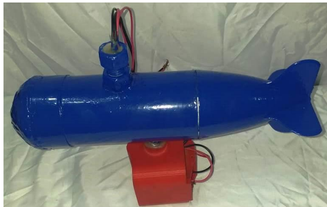
Figura 17. Prototipo de modelo de minisubmarino, el casco se muestra de color azul y el propulsor MHD en color rojo.
