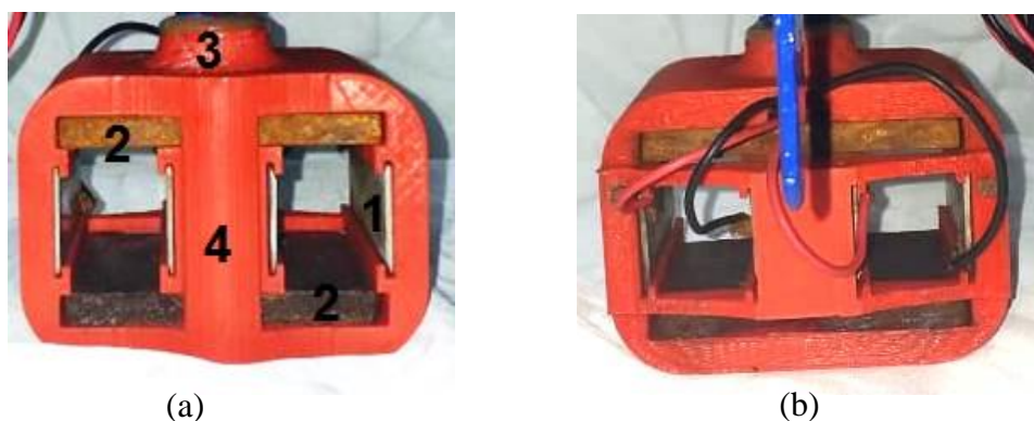
Figura 15: Vistas del propulsor MHD (a) Vista frontal con (1) placas de acero inoxidable (2) imanes de Neodimio (3) Unión roscada para el casco del modelo de minisubmarino (4) Carcasa del propulsor MHD (b) Vista posterior del propulsor MHD donde apreciamos las conexiones para el paso de la corriente eléctrica.
