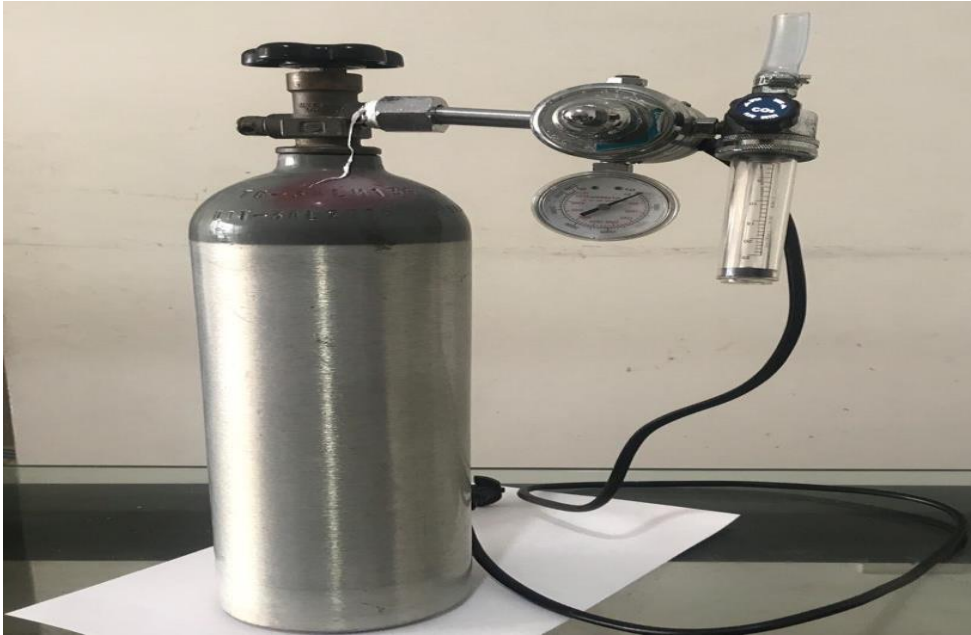
Tanque de dióxido de carbono
