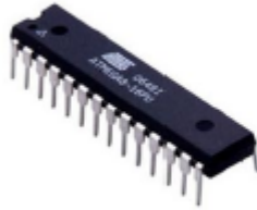
Figura 5.6. Especificaciones del microcontrolador ATMEGA328. [Elaboración Propia]
