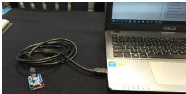
Figura 5.9. Conexión entre el XBee Coordinador y una PC. [Elaboración Propia]
