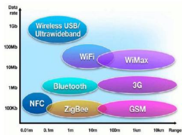
Figura 2.6. Gráfico de Tasa de transferencia vs. Rango, en el que se incluyen varias tecnologías inalámbricas.
