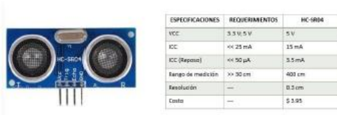
Figura 5.4. Especificaciones del módulo HC-SR04. [Elaboración Propia]
