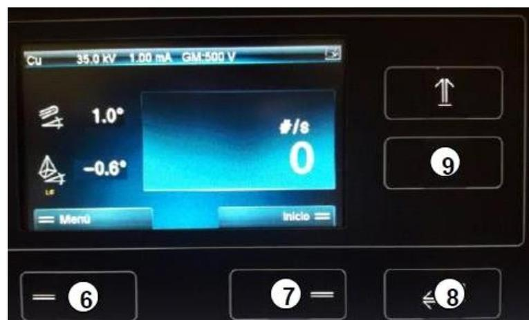
Figura 8. Botones del panel de control usados en el proceso de autocalibración del goniómetro. Captura de imagen desde la pantalla del monitor de la computadora.
