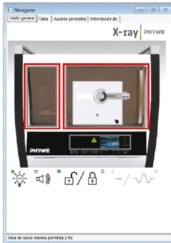
Figura 11. Ventana del Navegador del programa *Measure 4.6.15.3*. Captura de imagen desde la pantalla del monitor de la computadora.
