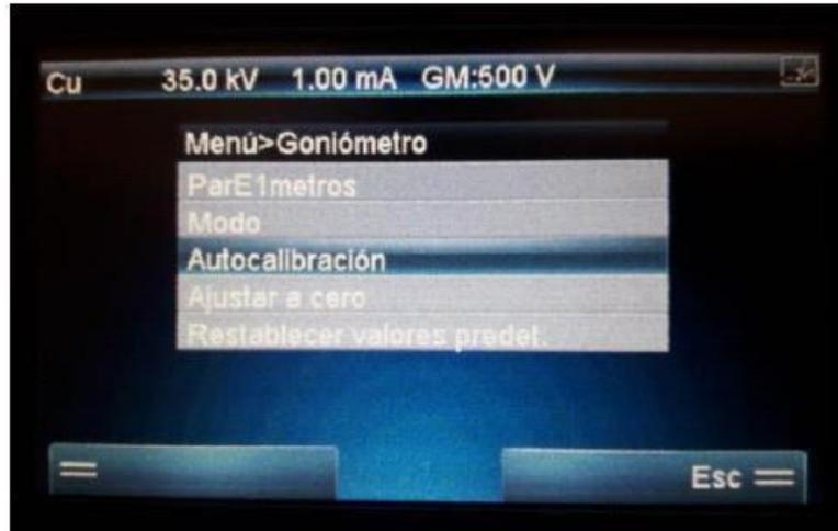
Figura 9. Display del equipo mostrando la selección de la función *Autocalibración*. Captura fotográfica de imagen desde la pantalla del equipo.
