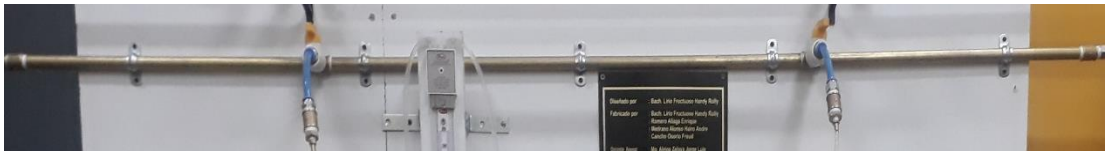
GRAFICO N° 4.26 LÍNEA DE PRUEBA N° 7 PARA TUBERÍA DE BRONCE DE \frac{1}{2} " DE DIÁMETRO
