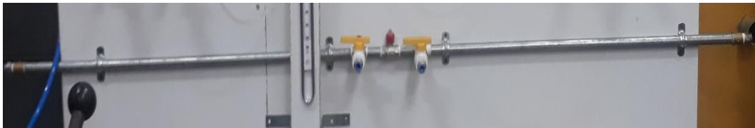
GRAFICO N° 4.18 LÍNEA DE PRUEBA N° 3 PARA VÁLVULA DE BOLA DE \frac{1}{2} "
