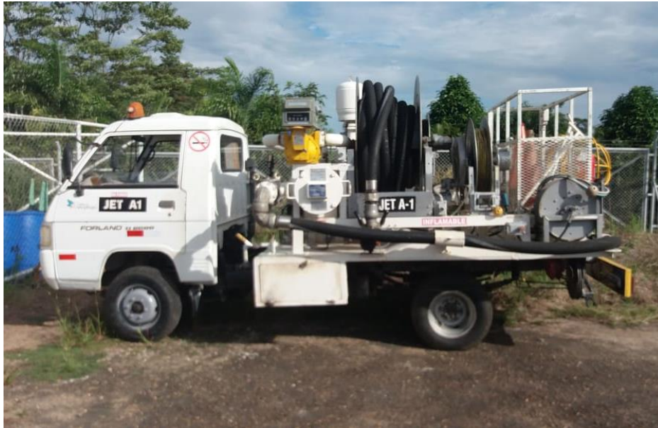
FIGURA 2: Camión hidrante para abastecimiento de combustible
