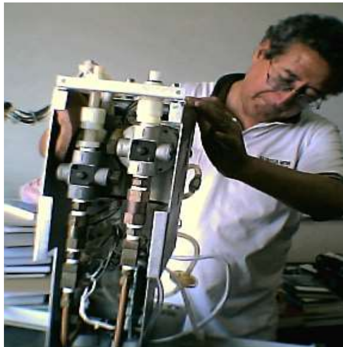
Figura N°31. Sistema Neumático de Ventilador Pulmonar Fuente: Elaboración propia
