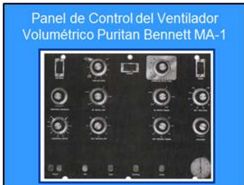
Figura N° 23. Panel de Ventilador -Puritan Bennett MA-1 Fuente: Apuntes de Electromedicina- Xavier Pardell
