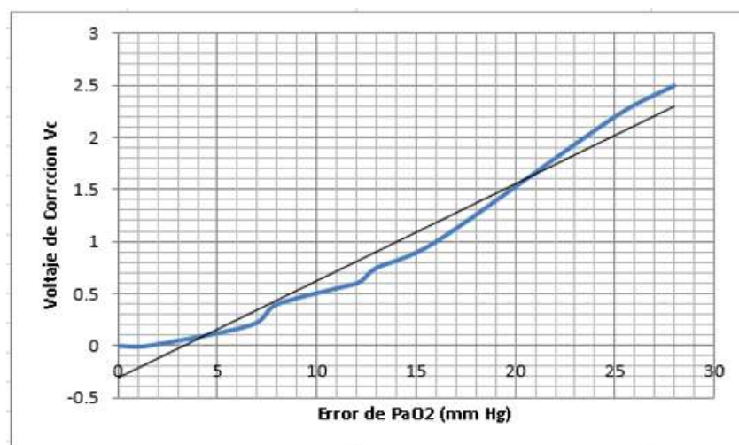
Grafico N° 13. Relación de entrada y salida del controlador Fuzzy para la corrección del FIO 2 Fuente: Elaboración propia
