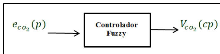
Figura N°83. Entrada y salida del controlador Fuzzy para la PaCO 2 Fuente: Elaboración propia
