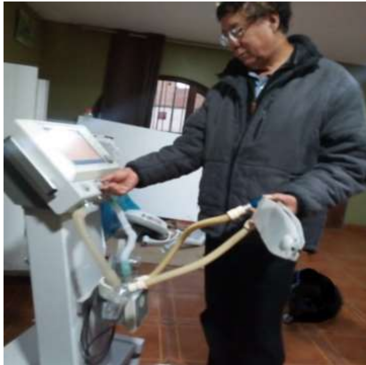
Figura N° 109. Ventilador Pulmonar y el simulador pulmonar Fuente: Elaboración propia
