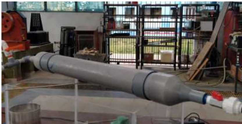
Figura 18 Lecho empacado con relleno de polietileno de alta densidad
