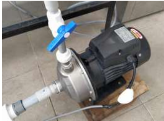
Figura 17 Bomba Centrífuga sanitaria Inoxidable de presión
