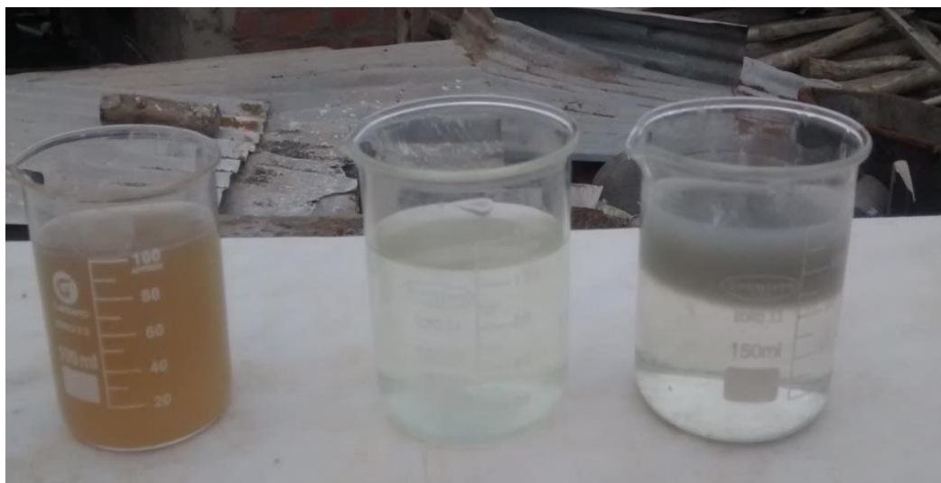
Figura 5.4. Vistas que corresponde a tres muestras del efluente domésticos, de izquierda a derecha, el primero es la muestra de ingreso, el segundo el de la salida y el tercero el efluente tratado en el interior de la celda del electrocoagulador del PSTCE, del 16 de setiembre de 2019.
