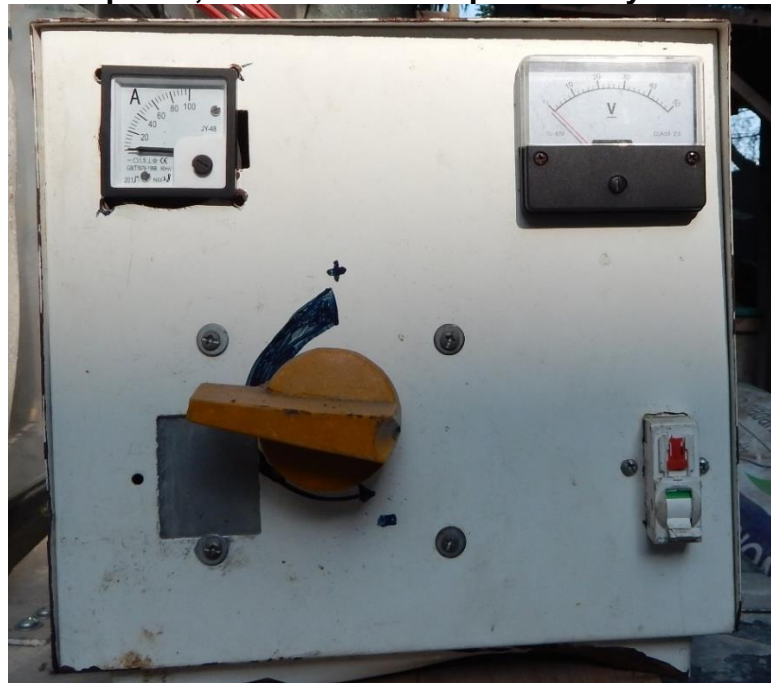
Figura 4.3. Fuente de poder, se observa el amperímetro y el voltímetro
