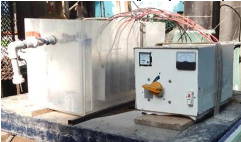
Figura 4.4. Se observa la Celda del electrocoagulador y la fuente de poder
