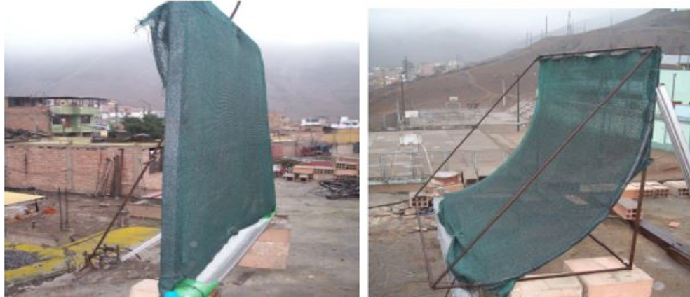
(a) ATRAPANIEBLAS CONVENCIONAL (b) ATRAPANIEBLAS SEMICICLOIDAL
