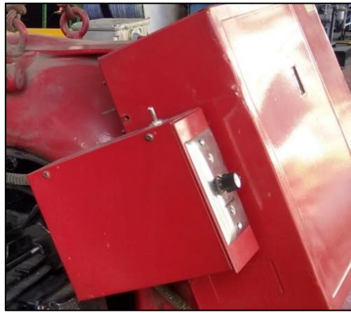
Figura 68: Instalación de Potenciómetro Honeywell
