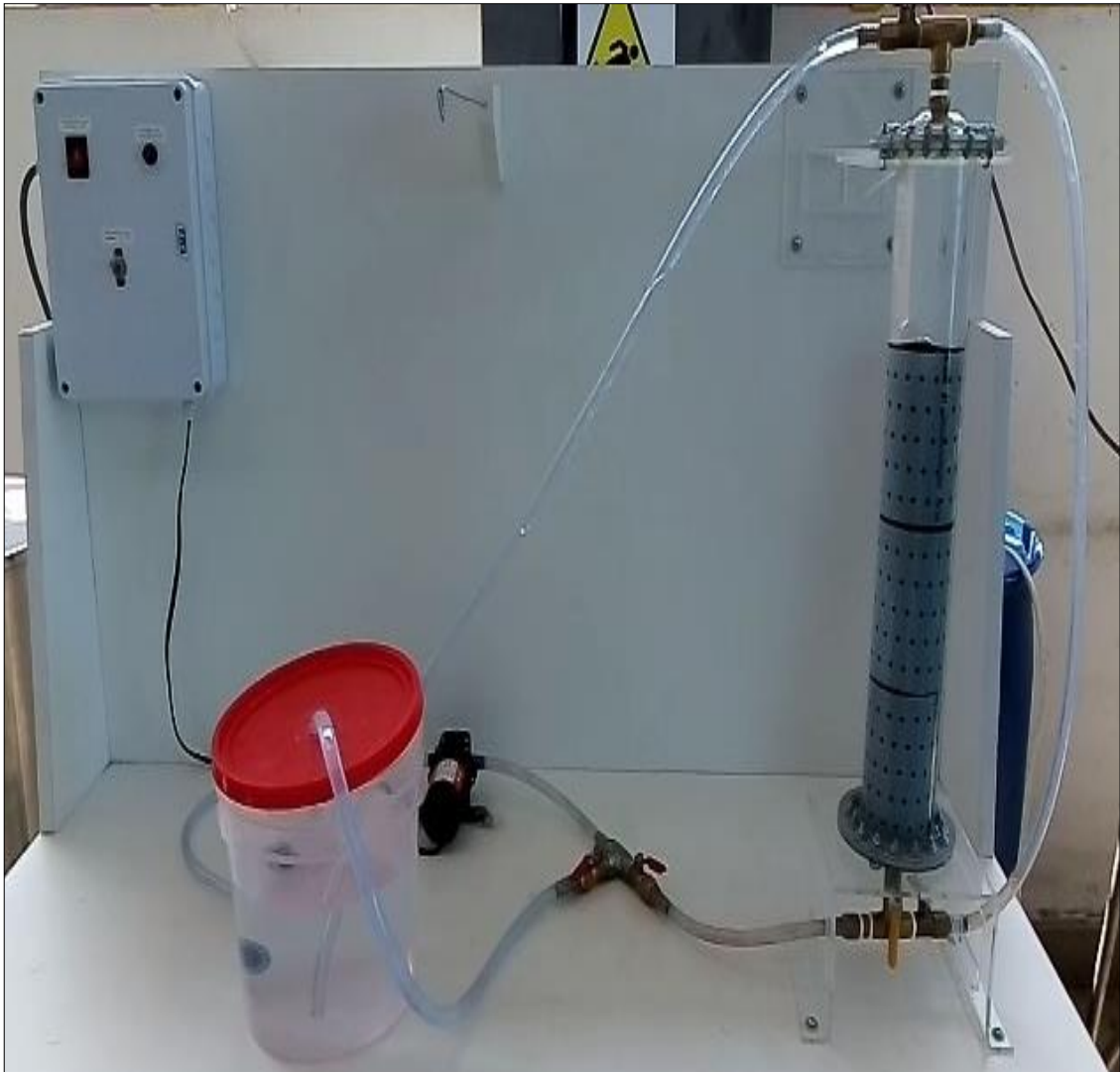
Figura 5. Equipo de Biosorción de columna fija con flujo continuo ascendente
