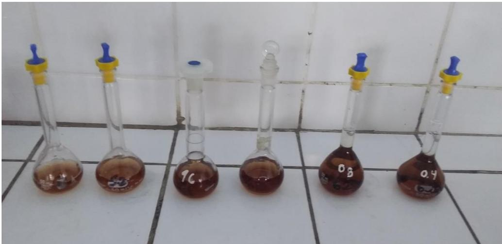
**Figura 13**, Preparación de muestras para medir Hierro, elaboración propia. Preparación de diluciones. F=50.
