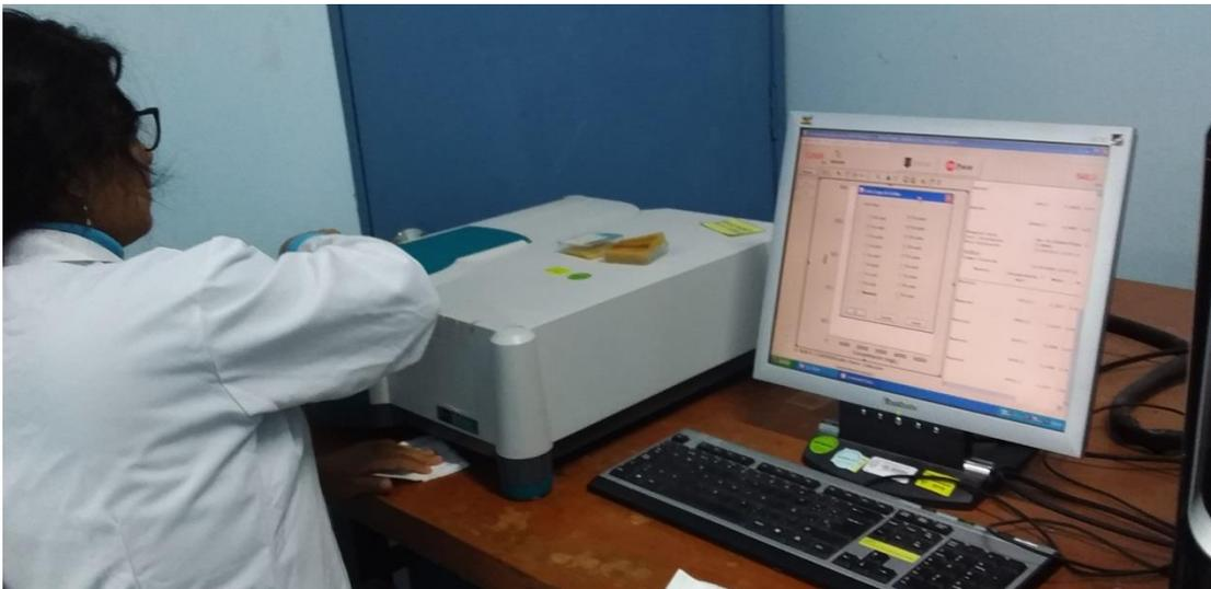
**Figura 15**, Medición de Proteínas, elaboración propia. Lectura en espectrofotómetro UV mediante el método de Biuret.
