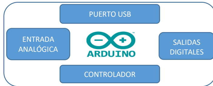
FIGURA N° 14 PERIFERIA DEL MICROCONTROLADOR
