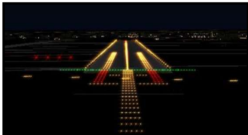
Figura N° 2.3 Sistema de Luces de Aproximación a través de un software de simulación. Fuente página especializada en Aeronáutica – Airvoila.com
