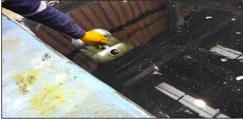
Figura 14: Toma de muestra del baño de decapado agotado
