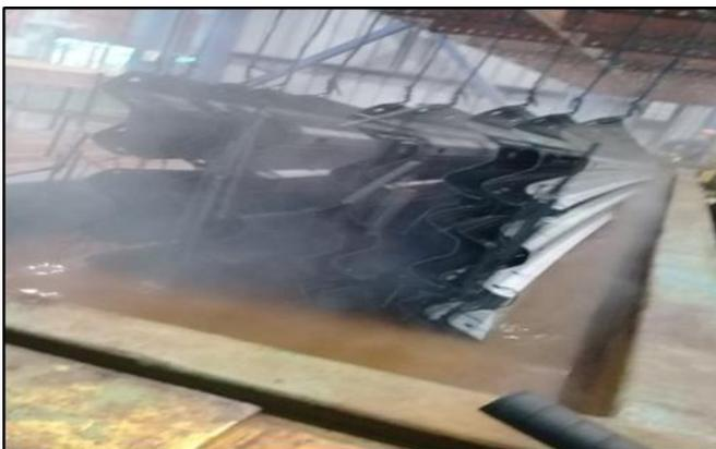
*Figura 5 :* Inmersión de piezas de acero en flux
