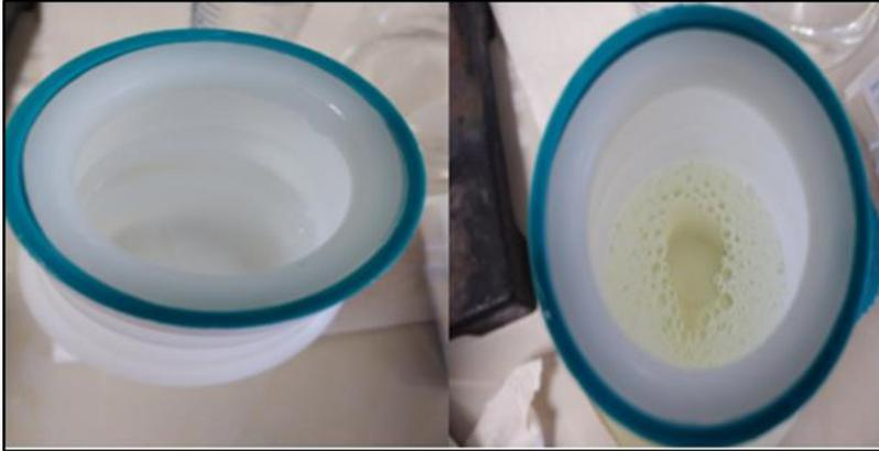
*Figura 4:* Baño de decapado sin aditivo y con aditivo
