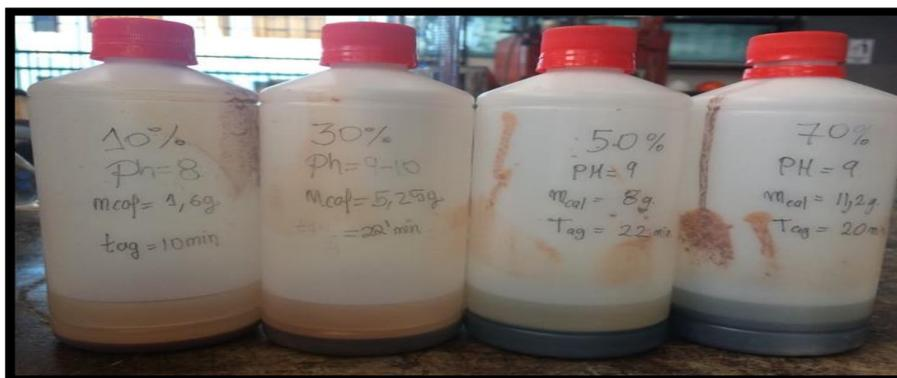
*Figura 16 : Dilución de muestras luego de la adición de  $\text{Ca(OH)}_{2(s)}$ .
