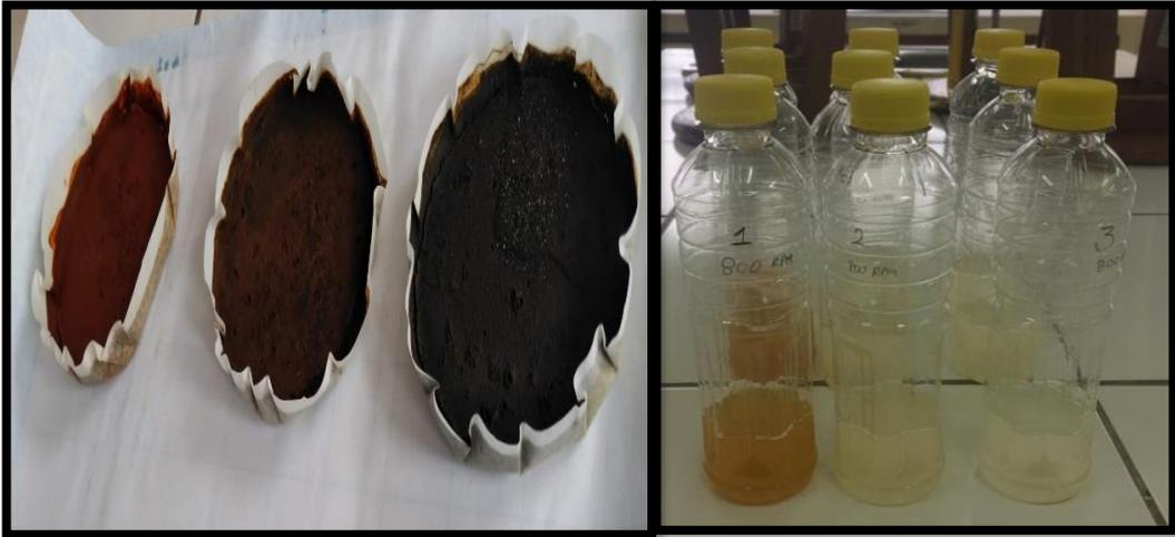
Figura 26 : Generación de torta (izquierda), liquido sobrenadante (derecha)
