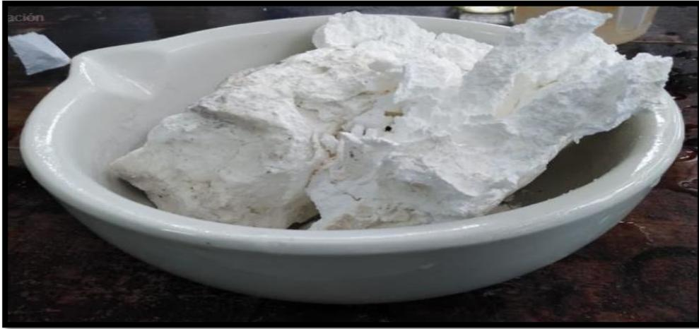
Figura 18: Resquebrajamiento del mineral luego de la hidratación
