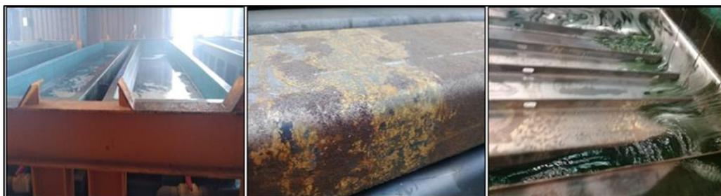
*Figura 3* : Baños de decapado en pieza de acero con óxido.
