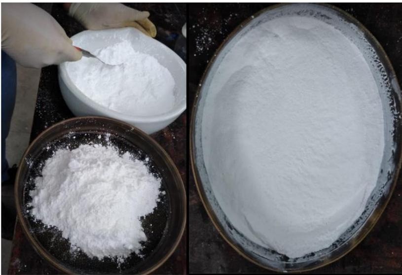
Figura 19: Tamizado de  $\text{Ca}(\text{OH})_{2(s)}$
