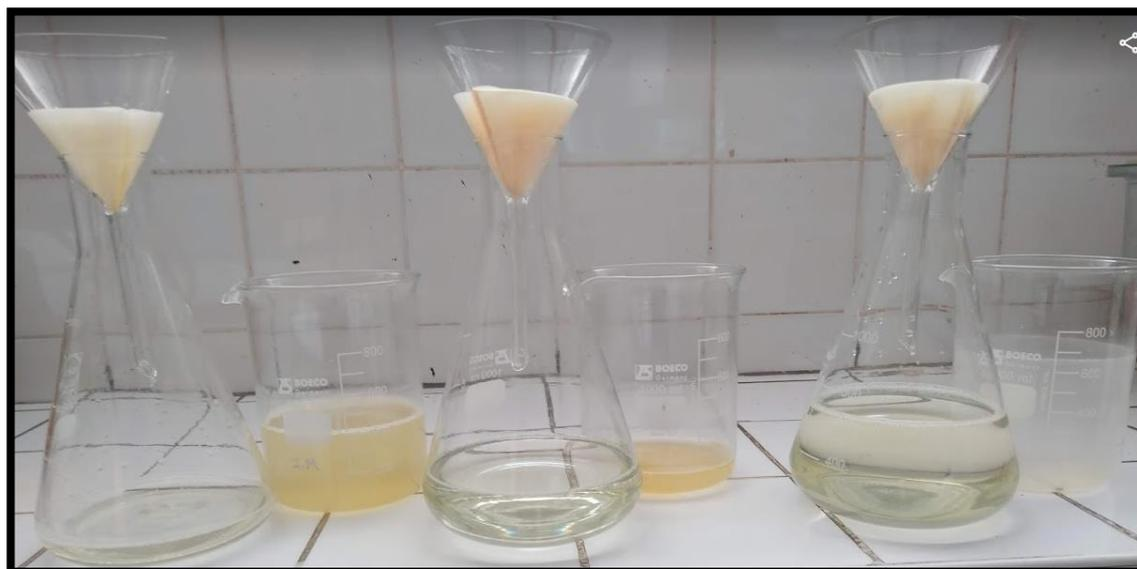
*Figura 25 : Muestras filtradas por gravedad*
