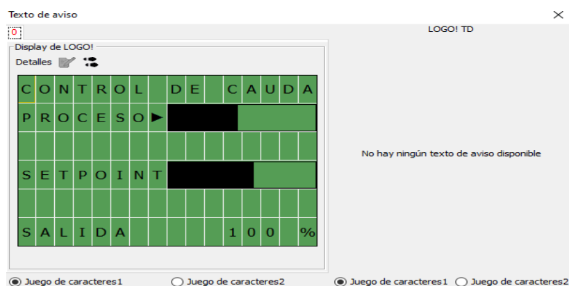
FIGURA N° 4.77 VISTA DE LA PANTALLA DEL PLC
