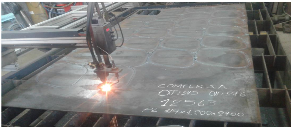
Proceso de oxicorte de planchas
