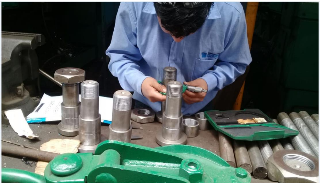
Figura N° 4.6 Verificación del control dimensional
