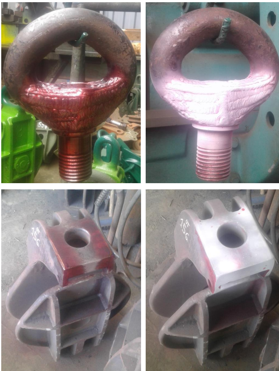
Figura N° 4.8 Inspección por líquidos penetrantes
