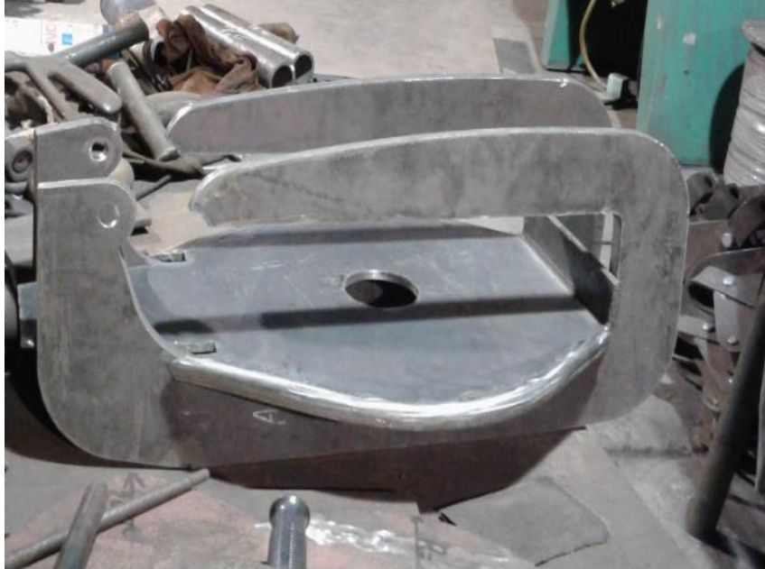
Figura N° 4.5 Montaje de la pasteca
