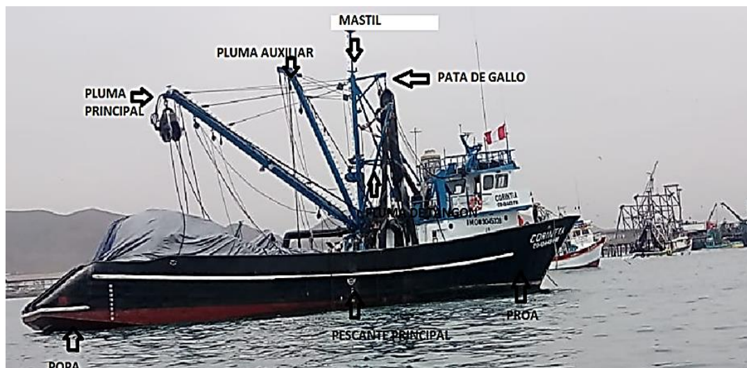
Componentes de un barco pesquero
