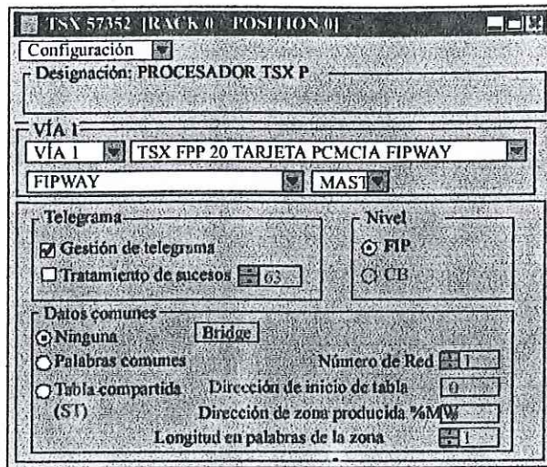
Fig. 8.9. Pantalla de configuración de la Comunicación FIPWAY del PL7.
