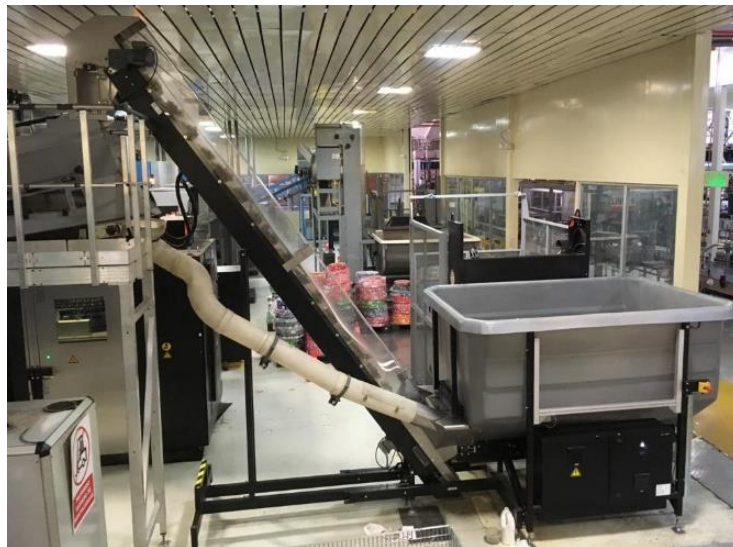
Figura N° 2.17 ALIMENTADOR DE PREFORMAS DETALLE DEL ELEVADOR E INGRESO AL HORNO
