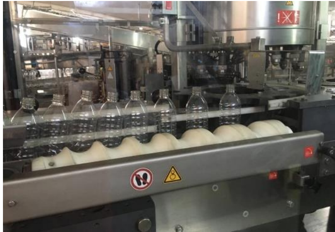
Figura N° 2.19 LAS BOTELLAS PASANDO POR EL TORNILLO SIN FIN DE LA ETIQUETADORA
