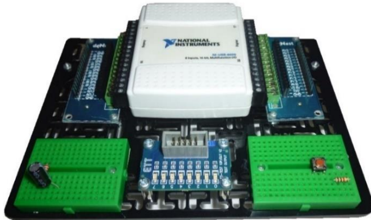
Figura N°05. Módulo físico de la tarjeta NIDAQ USB-6009.
