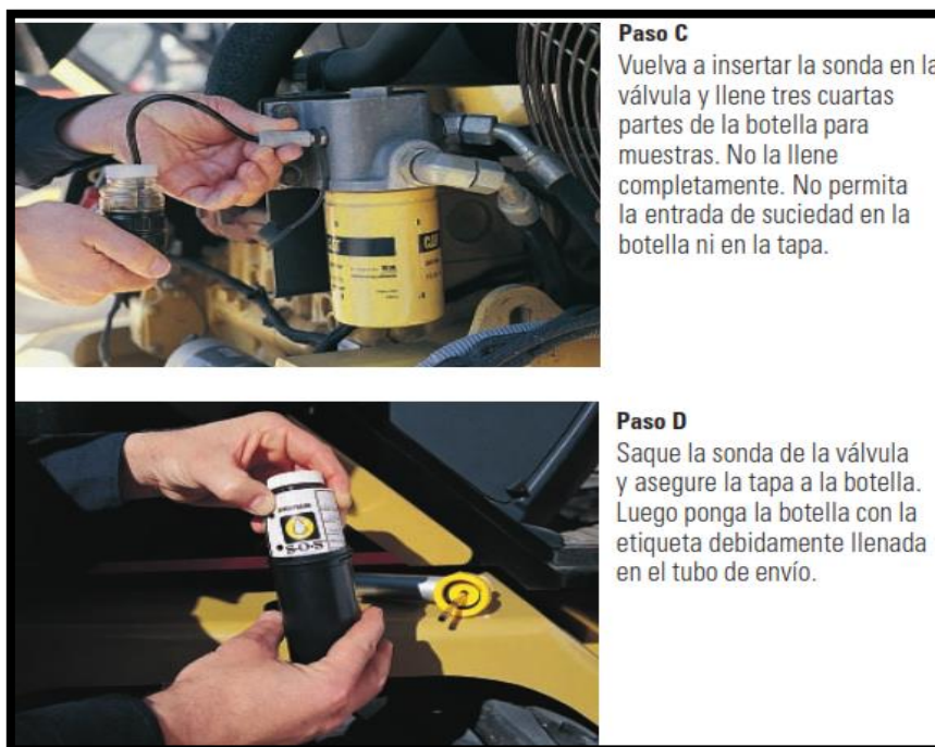
FIG.5.29. TOMA DE MUESTRA DE ACEITE USANDO UNA SONDA DE VALVULAS DE ACEITE.
