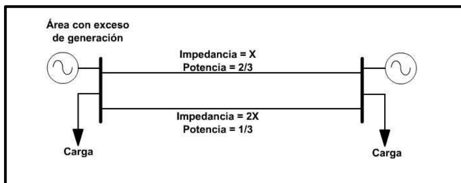
Figura 6. Flujo de potencia en líneas paralelas
