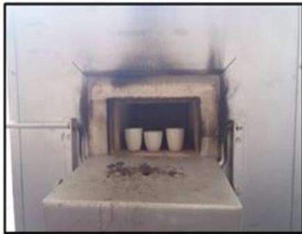
DETERMINACIÓN DE CENIZAS
