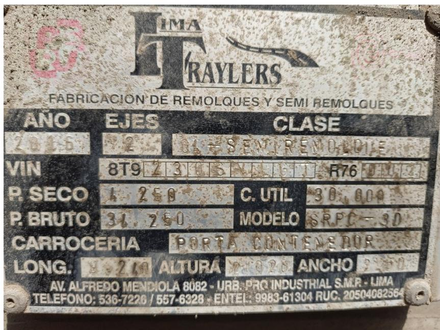
Figura 15 Plaqueta de fabricante
