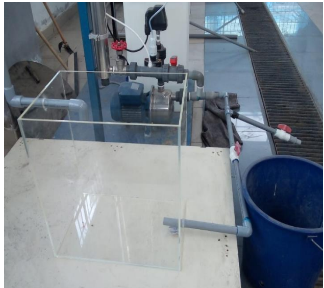
Figura 9. Instalación del tanque de almacenamiento de muestra
