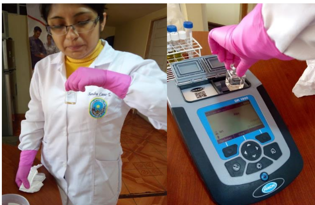
Figura 21. Lectura de absorbancias de muestras en el espectrofotómetro
