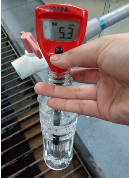
Figura 18. Toma de muestra, medición de pH y conservación en frío
