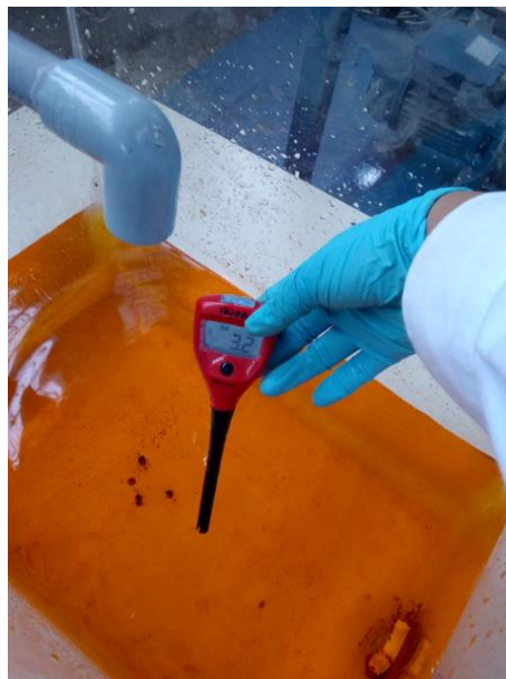
Figura 15. Medición del pH inicial en el tanque de almacenamiento
