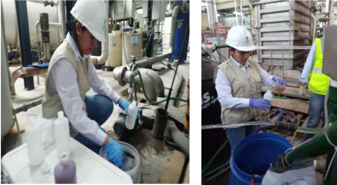
Figura 55. Muestreo de efluente residual pretratado en planta piloto textilera
