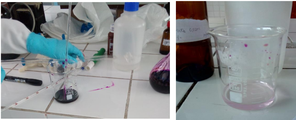
Figura 23. Análisis volumétrico con permanganato de potasio
