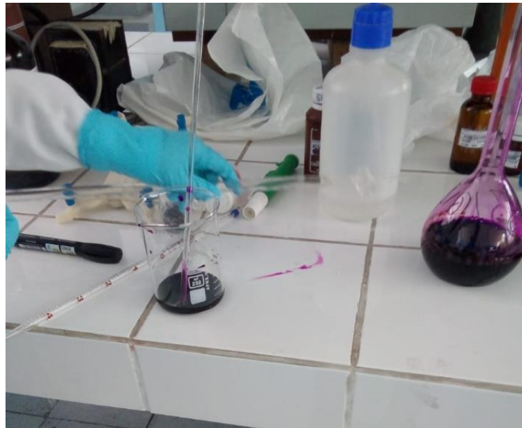
Figura 11. Análisis volumétrico de permanganometría
