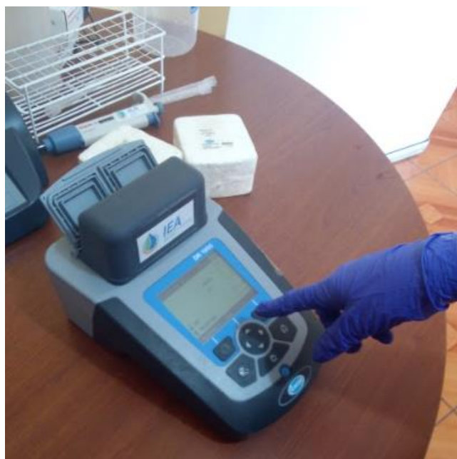
Figura 20. Espectrofotómetro VIS DR 1900 HACH
