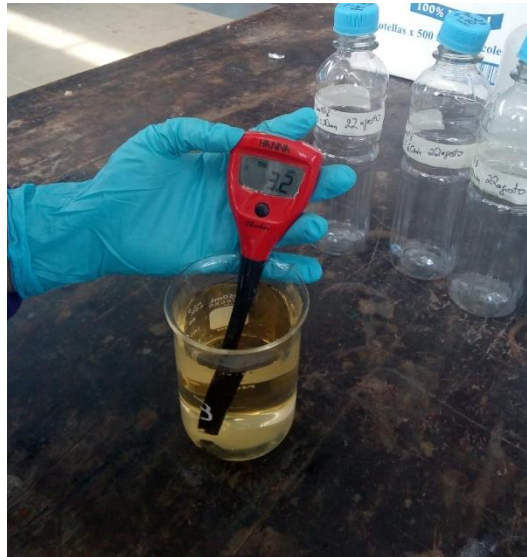
Figura 12. Uso del peachímetro portátil para ajuste de pH inicial
