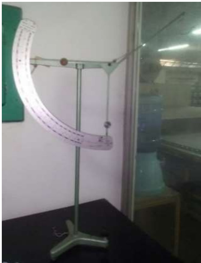
Figura 22. Balanza madejera para calcular título, Textilia S.A. (2017).
