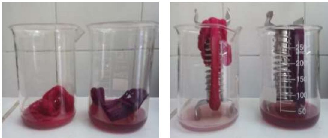
Figura 29. Teñido disperso con materiales poliéster y acrílico, Textilía S.A. (2017).
