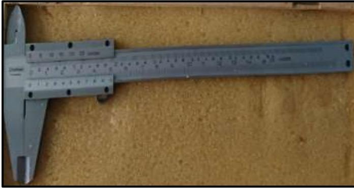
*Figura 27.* Calibrador de vernier
