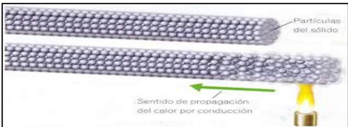
Figura 5 Mecanismo de conducción, Calor y luz
