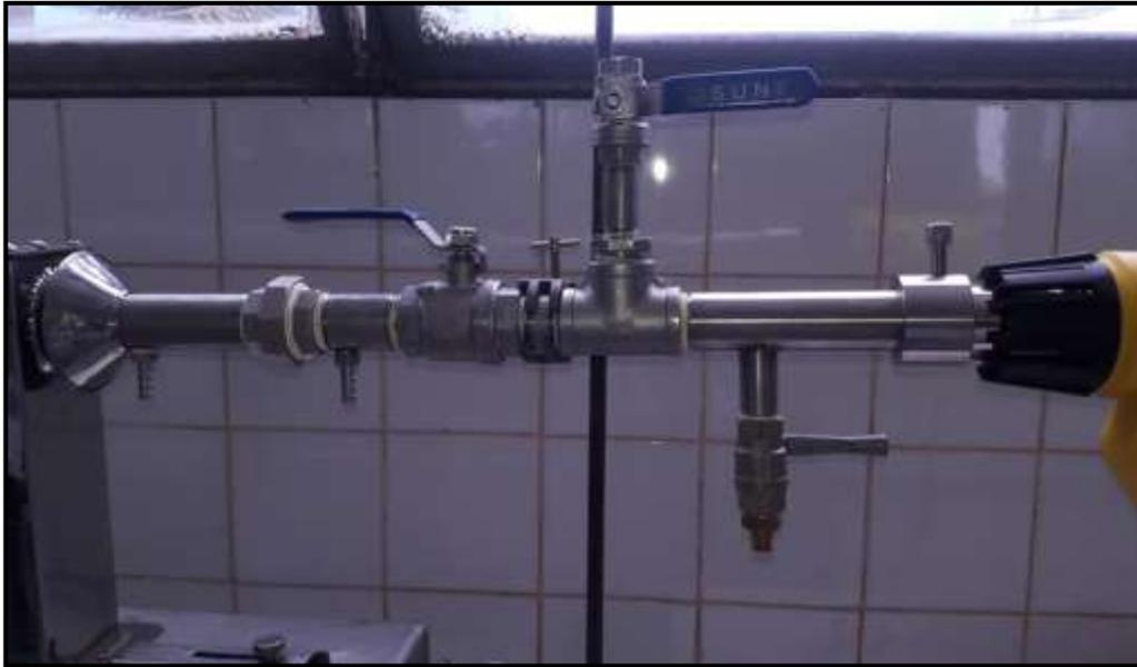
*Figura 17.* Tuberías para la entrada y salida de aire caliente
