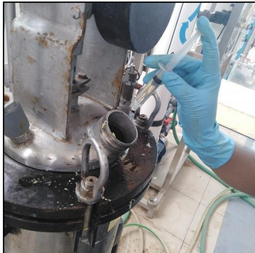
Figura 29. Adición de coagulante
