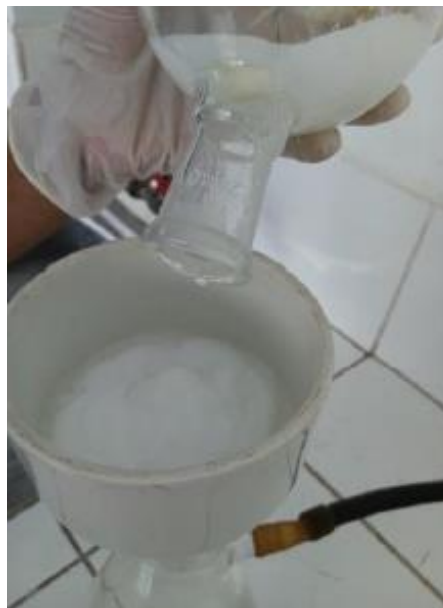
Accionar la bomba para generar vacío
