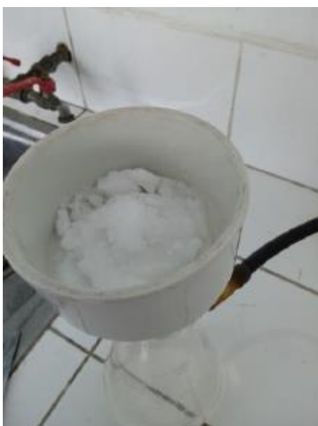
La fase sólida contiene el cloruro de potasio y sólidos sin reaccionar
