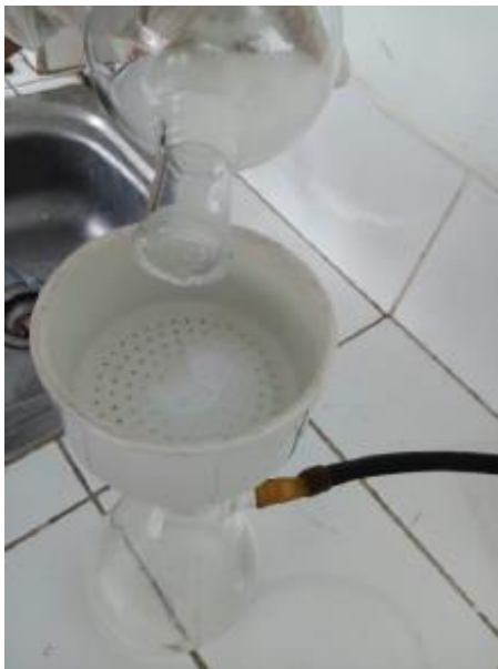
Vaciar la solución por el embudo Büchner
