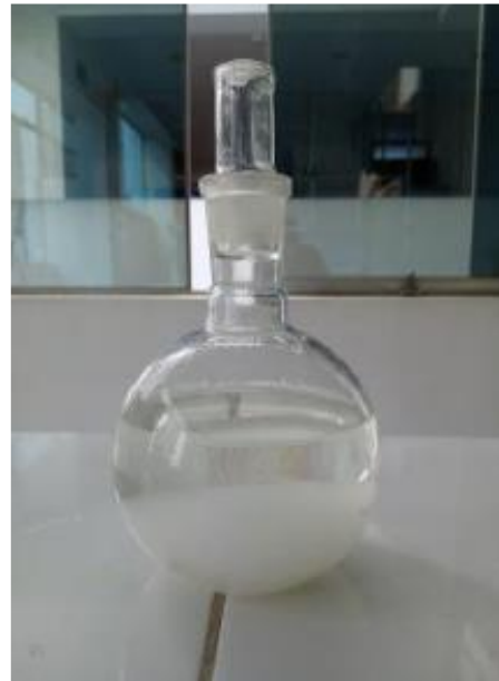
Disolver en una fiola de 100 ml
