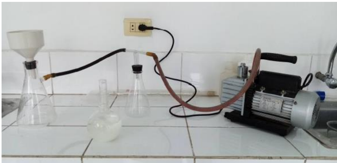
Proseguir con una separación al vacío para obtener el lactato de benzalconio
