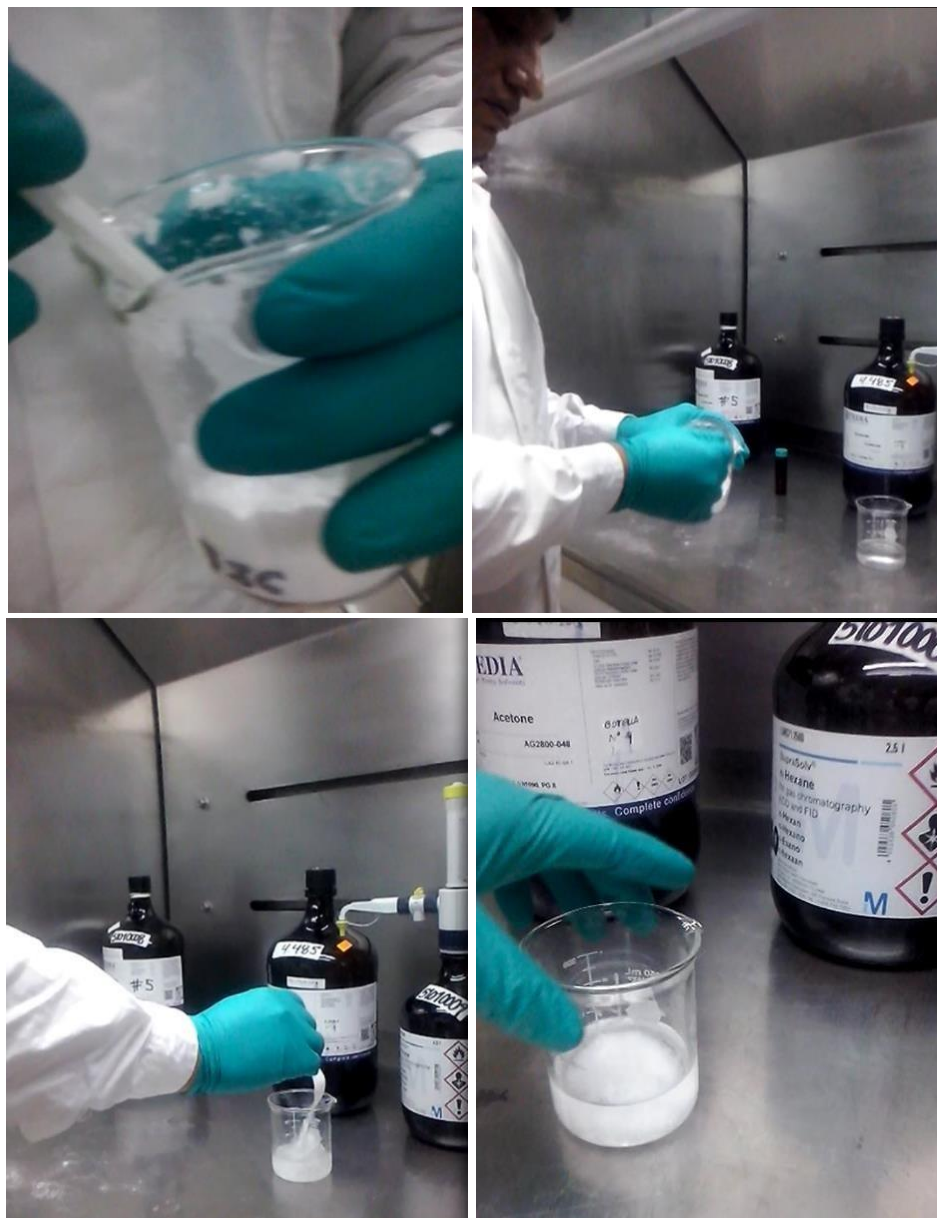
Figura 26: Secar el Extracto Usando Sulfato de Sodio Anhidro, FUENTE: Propia.
