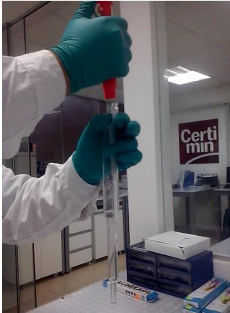
Figura 29: Colocar la muestra Concentrada en el Vial, FUENTE: Propia Nota: En la figura se observa el trasvase de la muestra concentrada al vial.
