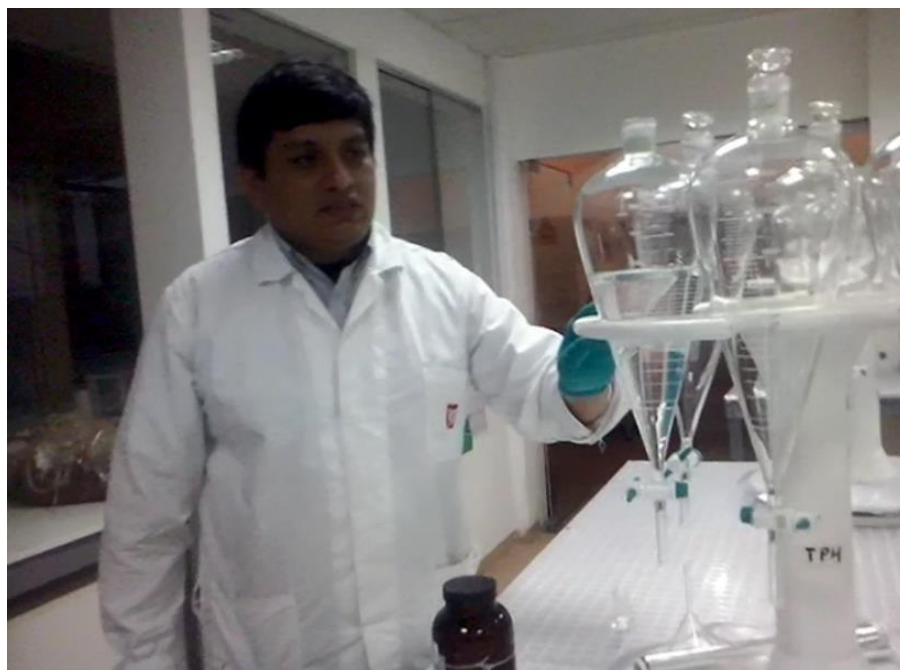
Figura 21: Trasvase de la Muestra al Tubo de Decantación, Fuente: propia.
