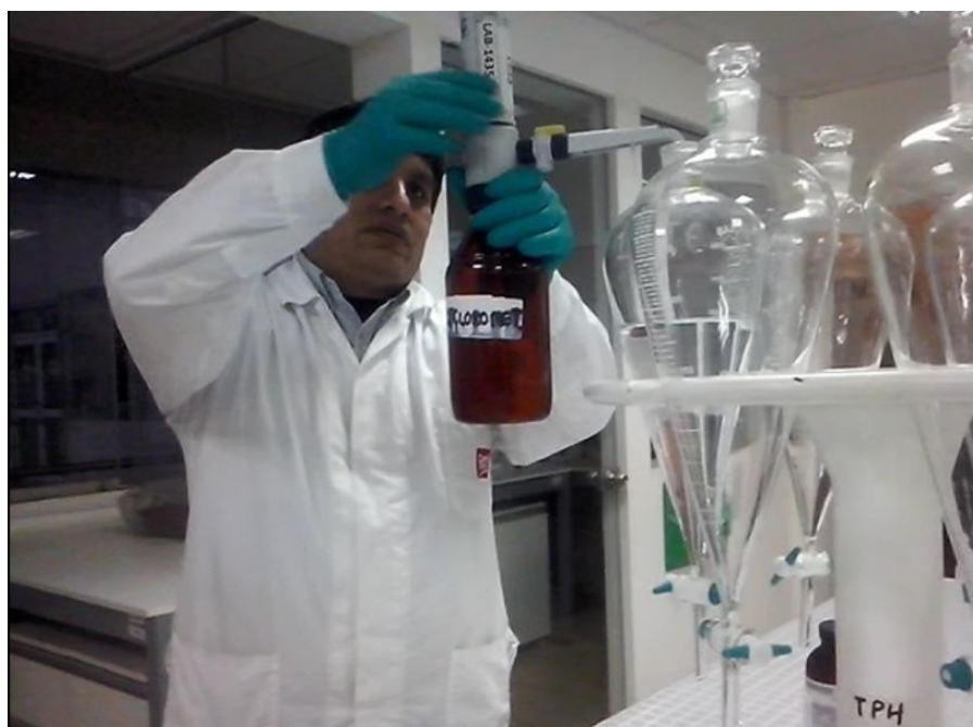
Figura 22: Agregar Diclorometano a la Muestra de Agua, Fuente Propia
