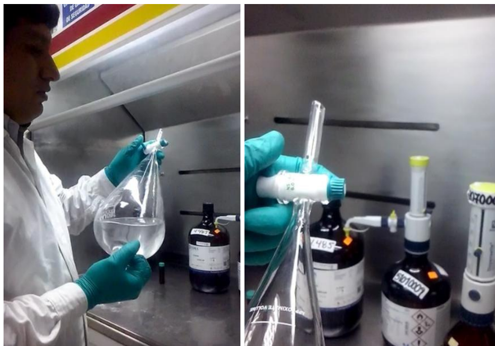
Figura 23: Agitar y Desgasificar dentro de la Campana Extractora, FUENTE: Propia
