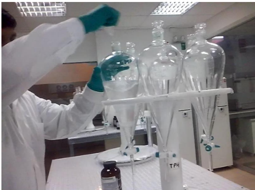
Figura 24: Dejar que el Solvente Precipite por Gravedad, FUENTE: Propia.
