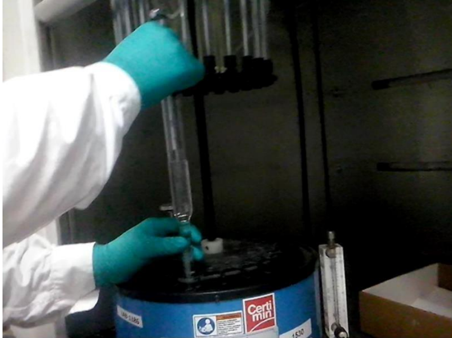
Figura 28: Colocar el tubo en el Concentrador de Muestras, FUENTE: Propia
