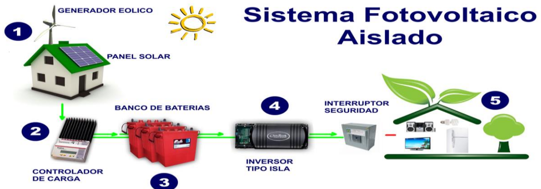
Figura 2. 15 Sistema Fotovoltaico Aislado
