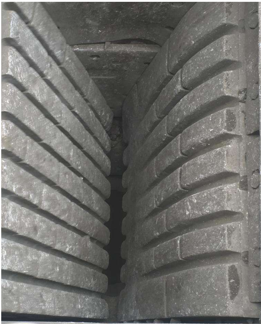
Figura 2-4: Muelas de la chancadora Primaria Sandvik CJ412
