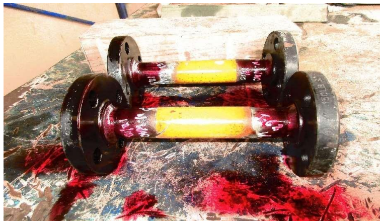
FIGURA 4.40 APLICACIÓN DE TINTES PENETRANTES
