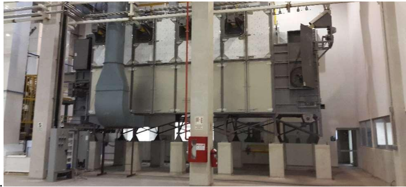
FIGURA 2.12 SECADOR - PLANTA DE ALIMENTOS PARA MASCOTAS MOLITALIA / CAJAMARQUILLA
