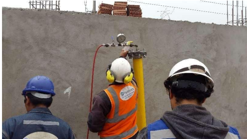
FIGURA 4.41 PRUEBA DE HERMETICIDAD - RED INTERNA
