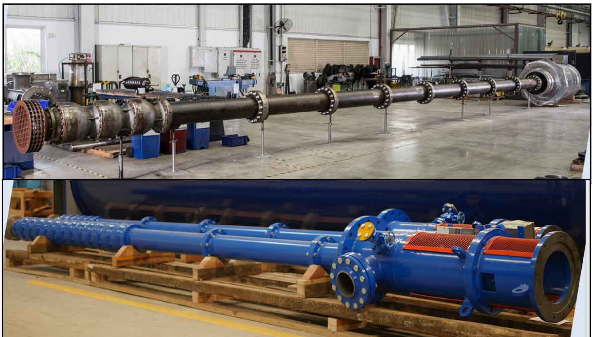
Figura N°9. Proyecto Quellaveco (Bombas Verticales - Impulsión Agua)
