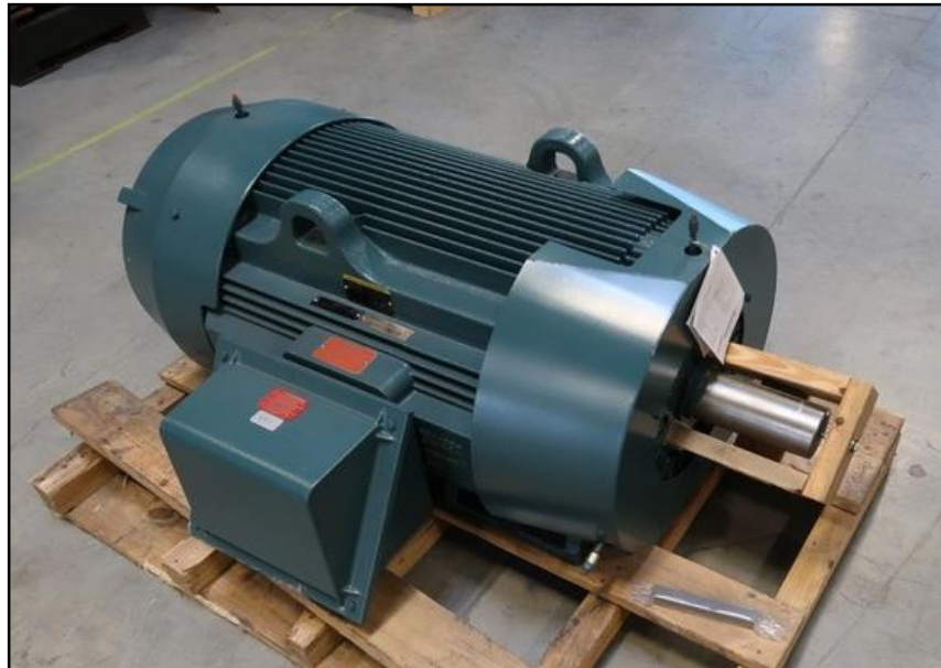
Figura N° 69 Motor eléctrico 3/60/460 de 300 HP
