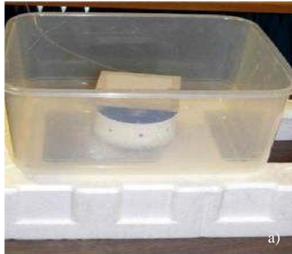
Figura 04 Antena de parche instalado sin líquido, horizontal de arriba Fuente: IEEE Trans. Microw. Theory Tech., vol. 52, no. 8, 2004
