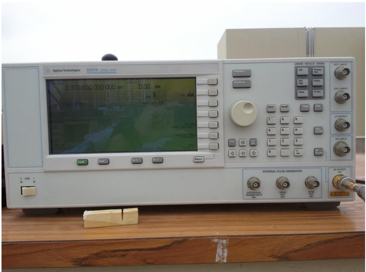
Figura 51 Generador de señales sintonizado a la frecuencia de trabajo de 3.3 GHz
