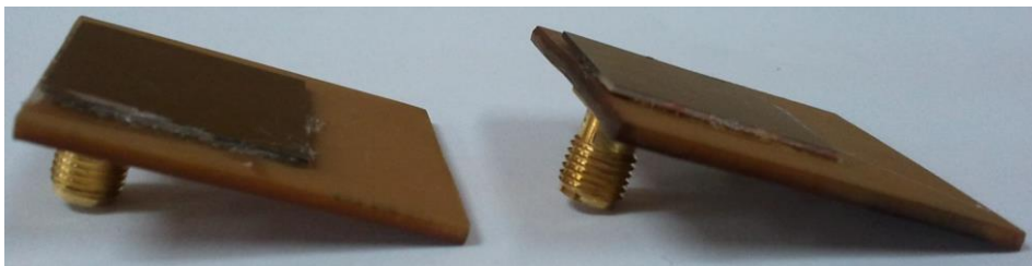
Figura 42 Radiadores de parche de microcinta de nitruro de titanio y plata (transmisor y receptor) Fuente: Elaboración propia
