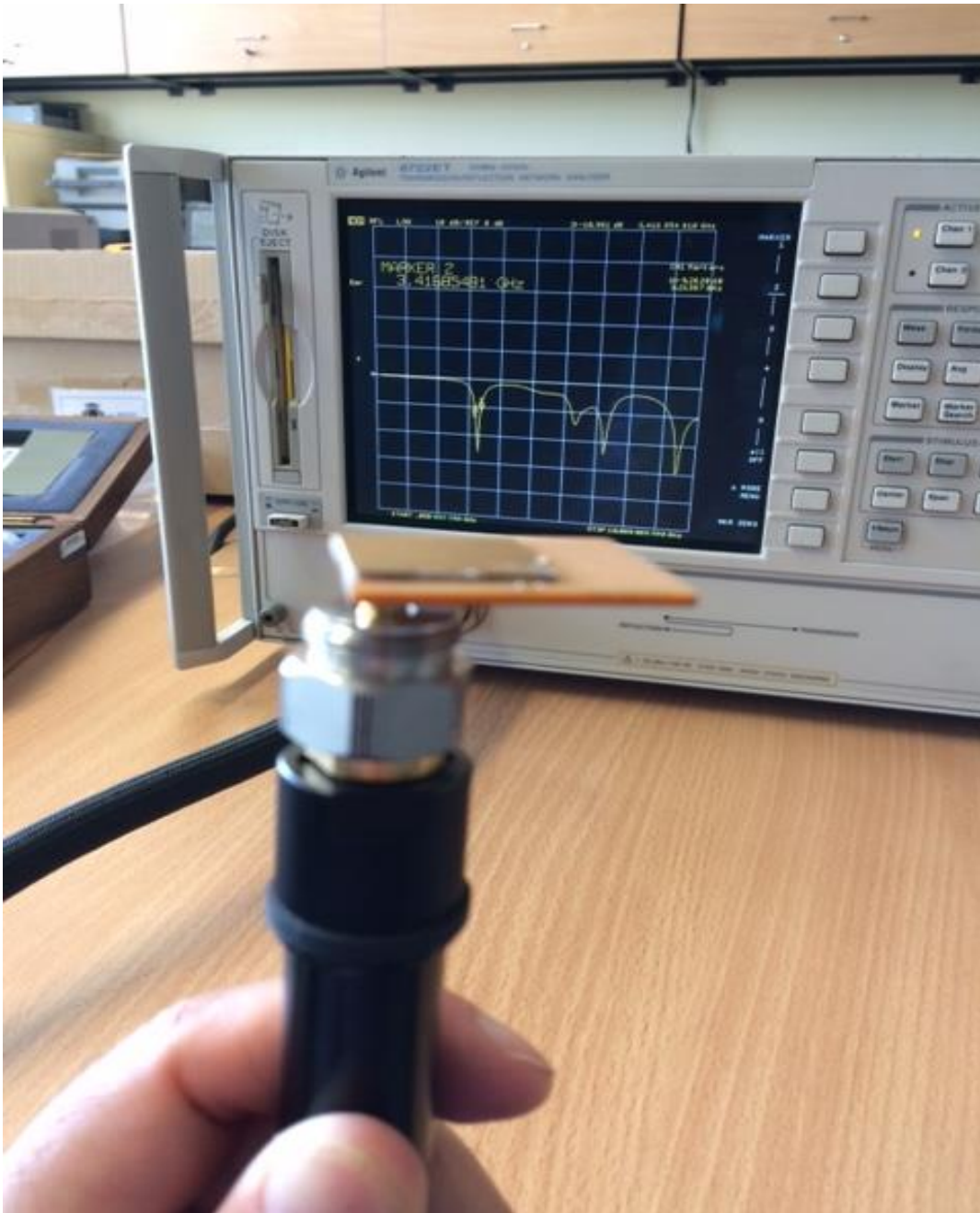
Figura 46 Radiador de microcinta montado, puede ser un emisor y/o receptor de microondas, conectado al Analizador de espectros Agilent 6722E
