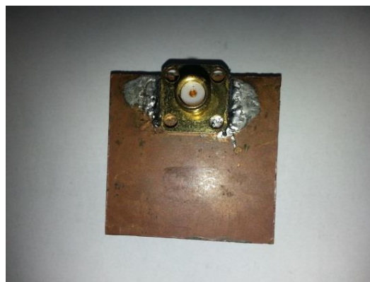
Figura 43 Radiador de parche de microcinta en tres vistas. Fuente: Elaboración propia
