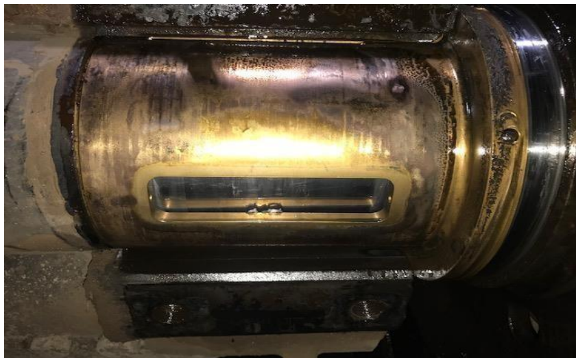
Figura 3.20: Verificación del juego radial en las chumaceras
