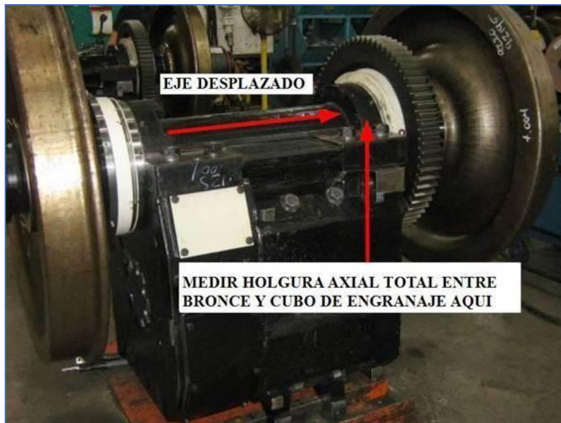
Figura 3.21: Verificación del juego axial con el motor de tracción ensamblado
