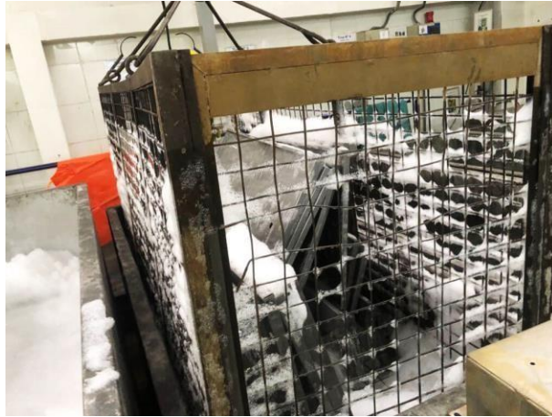
Figura 22. Pre-tratamiento de pintado, limpieza química con fosfato. Tomada de Metal 5000 CNC, 2019. Recuperado de:
