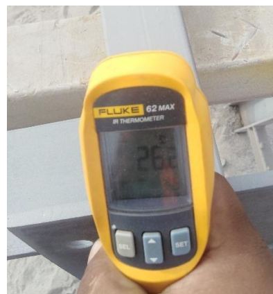
Figura 72. Termómetro de superficie. Certificado de calibración anexo 5.
