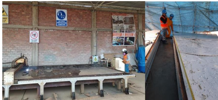
Figura 55. Corte y medición de planchas de acero ASTM A36 en taller.
