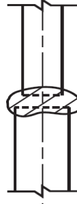
Figura 60. Soldadura horizontal con ranura cuadrada. Tomada de "Welded Tanks for Oil Storage", por API estándar 650, 2013, p.[5-4].
