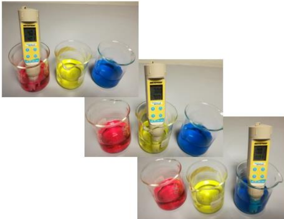
Figura 03. Procedimiento para la calibración del equipo multiparámetro PCSTestr 35.
